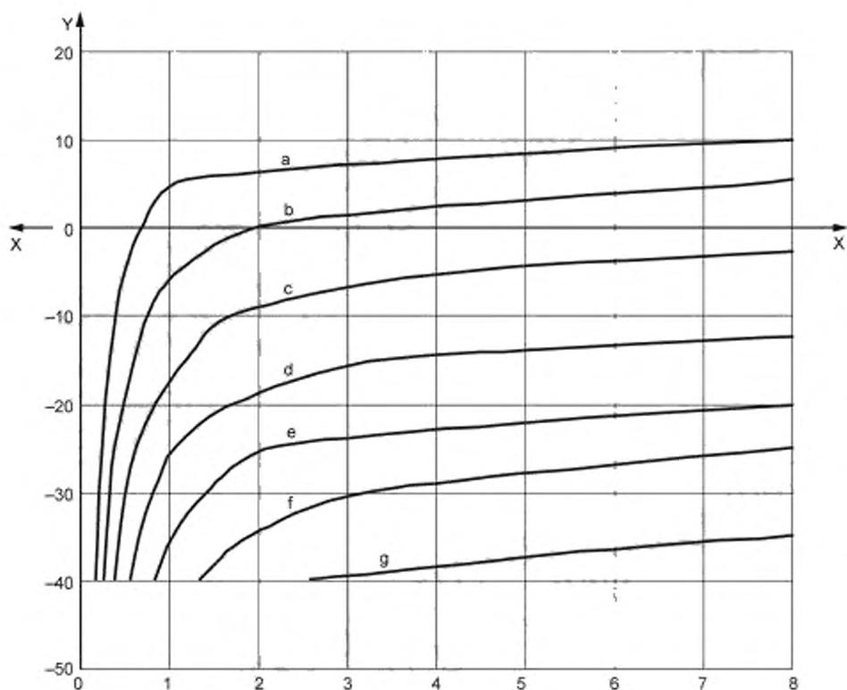
X --  $D_{lim}$ , мин; Y -- рабочая температура  $t_{gr}$ , °C; скорость воздуха — 0,4 м/с; воздушная проницаемость внешнего слоя — 8 л/(м<sup>2</sup>·с);
