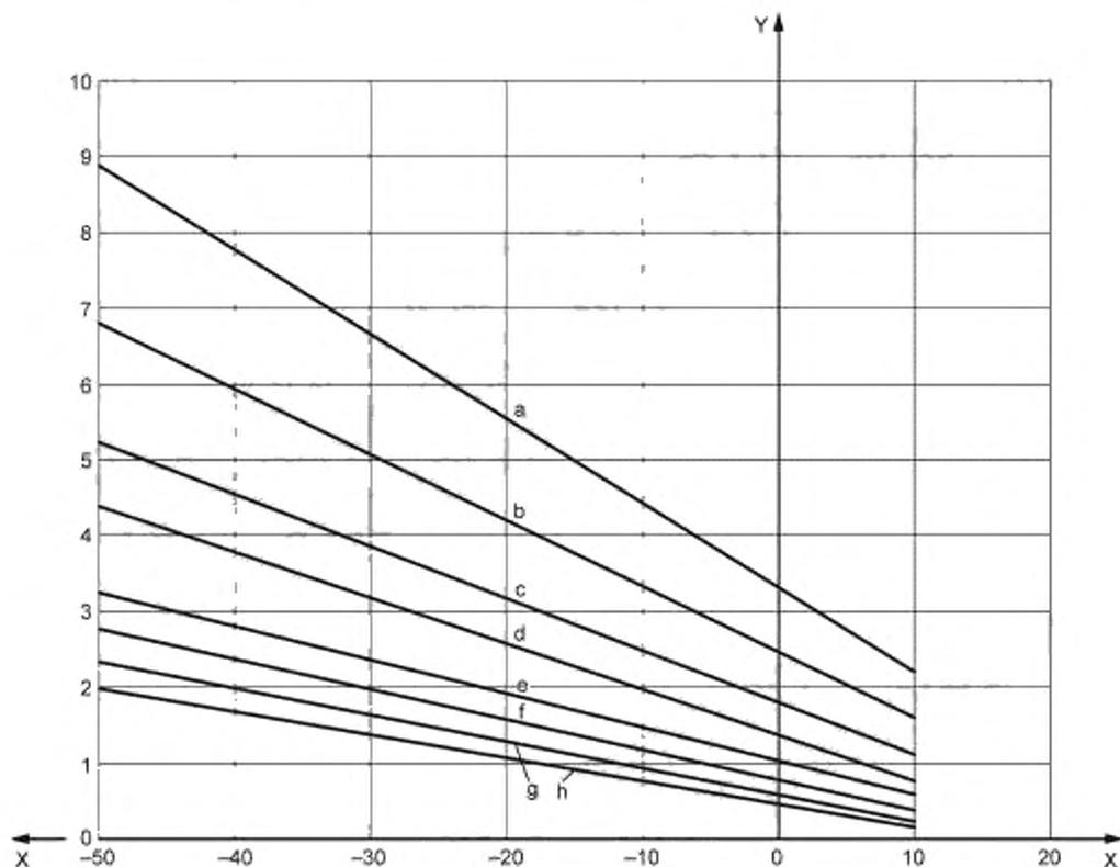
X — рабочая температура,  $t_{op}$ , °C; Y — IREQ, кло, скорость воздуха — 0,4 м/с; воздушная проницаемость внешнего слоя — 8 л/(м²·с); a — 70 Вт/м², b — 90 Вт/м², c — 115 Вт/м², d — 145 Вт/м², e — 175 Вт/м², f — 200 Вт/м², g — 230 Вт/м², h — 260 Вт/м²
