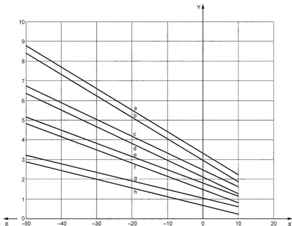
X — рабочая температура  $t_{dr}$ , °C; Y — IREQ, ккло; скорость воздуха — 0,4 м/с; воздушная проницаемость внешнего слоя — 8 л/(м<sup>2</sup>·с);
