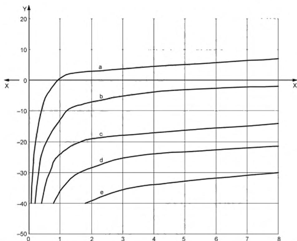
$X$  —  $D_{lim}$ , ч;  $Y$  — рабочая температура  $t_0$ , °C; скорость ветра — 0,4 м/с; воздушная проницаемость внешнего слоя — 8 л/(м<sup>2</sup>·с);
