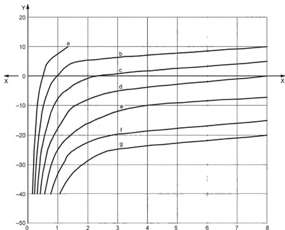
$X - D_{lim}$ , ч,  $Y -$  рабочая температура  $t_o$ , °C; скорость воздуха  $- 0,4$  м/с; воздушная проницаемость внешнего слоя  $- 8$  л/(м<sup>2</sup>·с);
