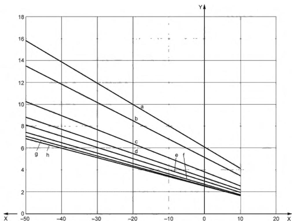
X — рабочая температура  $t_p$ , °C; Y — IREQ, ккло; скорость воздуха — 0,4 м/с; воздушная проницаемость внешнего слоя — 8 л/(м<sup>2</sup>·с); а — 15 м/с, б — 10 м/с, с — 5 м/с; д — 3 м/с; е — 2 м/с; ф — 1 м/с; г — 0,5 м/с; h — 0,2 м/с
