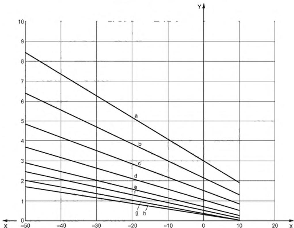
X — рабочая температура  $t_{op}$ , °C; Y — IREQ, ккал; скорость воздуха — 0,4 м/с; воздушная проницаемость внешнего слоя —  $8 \text{ л}/(\text{м}^2 \cdot \text{с})$ ; a —  $70 \text{ Вт}/\text{м}^2$ ; b —  $90 \text{ Вт}/\text{м}^2$ ; c —  $115 \text{ Вт}/\text{м}^2$ ; d —  $145 \text{ Вт}/\text{м}^2$ ; e —  $175 \text{ Вт}/\text{м}^2$ ; f —  $200 \text{ Вт}/\text{м}^2$ ; g —  $230 \text{ Вт}/\text{м}^2$ ; h —  $260 \text{ Вт}/\text{м}^2$
