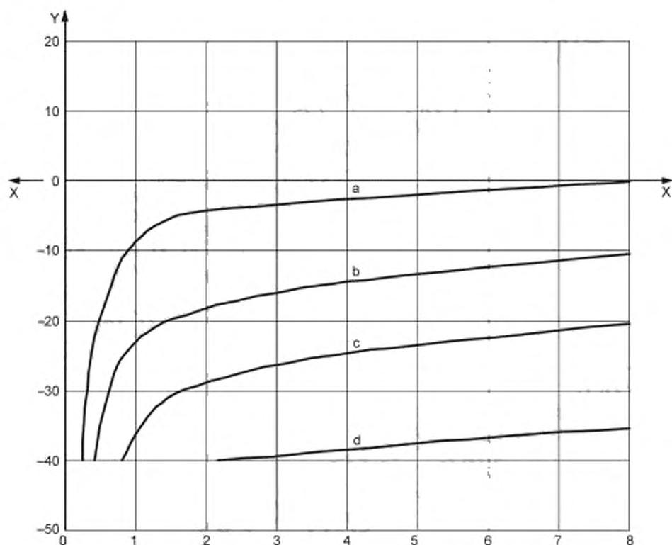
$X$  —  $D_{lim}$ , ч,  $Y$  — рабочая температура  $t_{0r}$ , °C; скорость ветра — 0,4 м/с; воздушная проницаемость внешнего слоя — 8 л/(м<sup>2</sup>·с);
