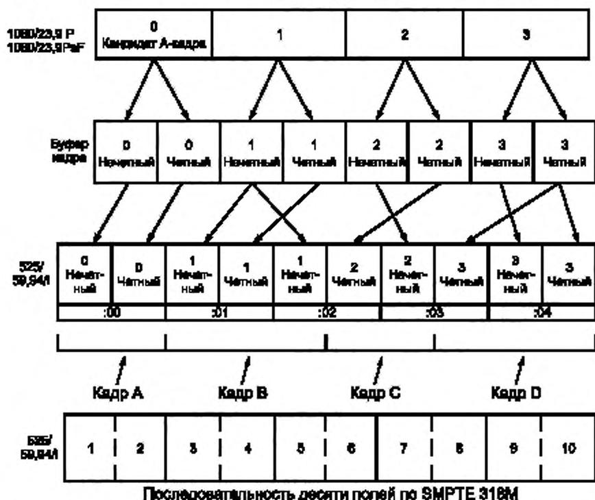
Рисунок В.1 — Пример преобразования видеосигнала с частотой 23,98 кадр/с в видеосигнал с частотой 525/59,94/строка
