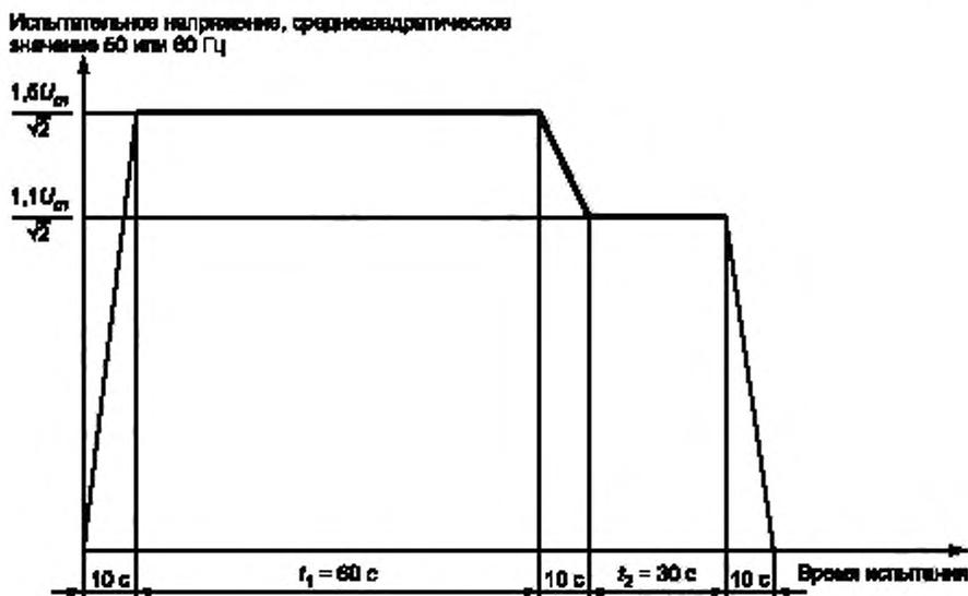
$U_m$  — самое высокое периодическое пиковое напряжение в соответствующем напряжении изоляции
