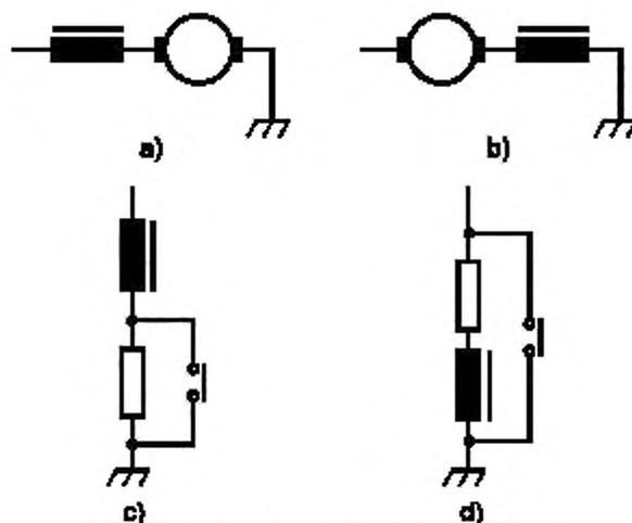
а) и б) — соединение обмотки возбуждения/якоря электродвигателя с последовательным возбуждением
