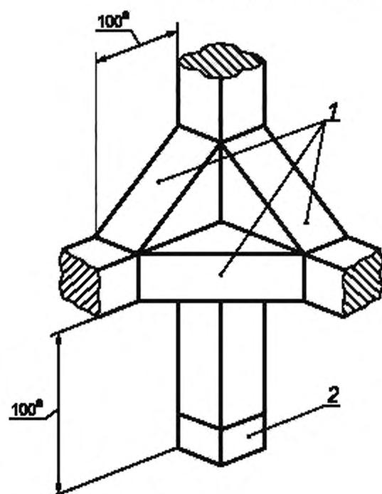
1 — детали углового крепления каркаса камеры, приклеенные и закрепленные шурупами;
