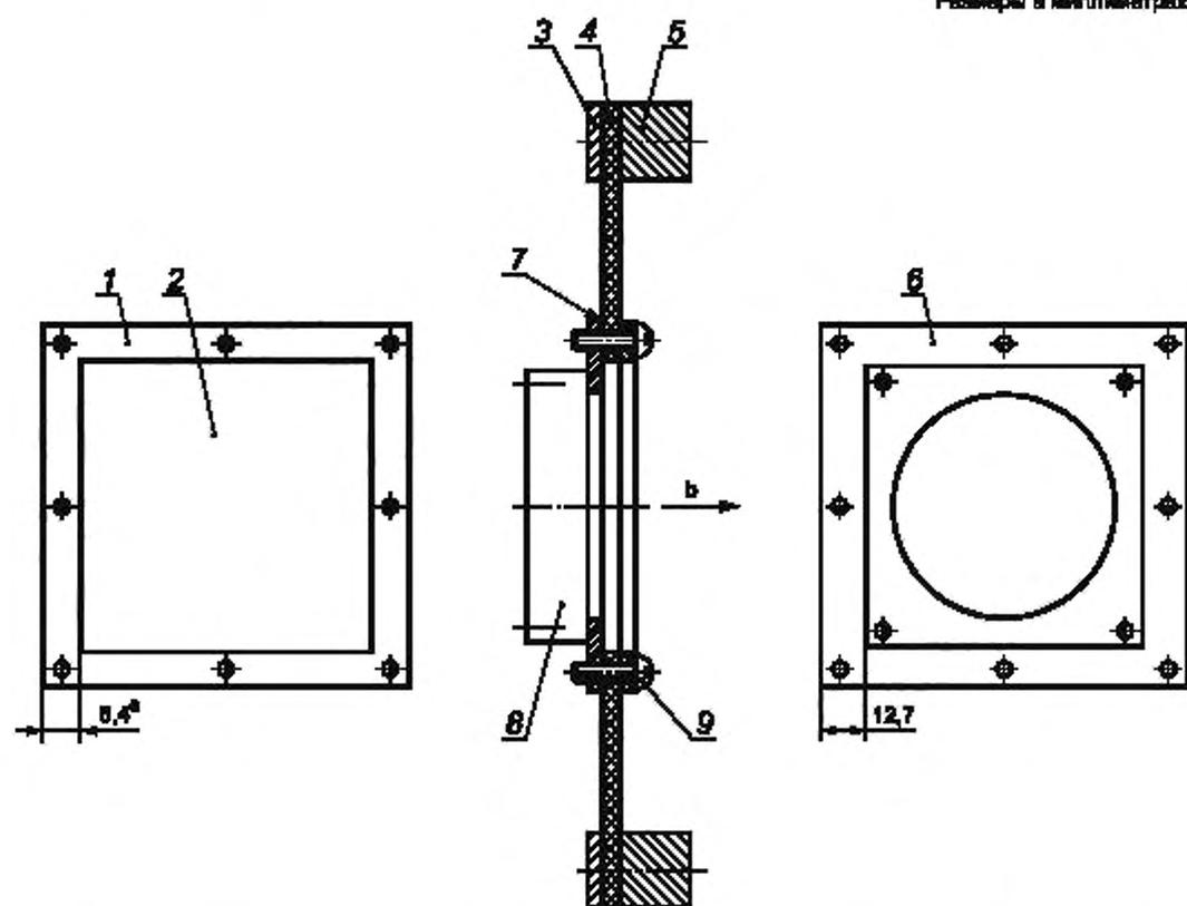
1 — прижимная накладка (алюминий толщиной 3,2 мм); 2 — вырез; 3 — крепежная алюминиевая полоса, закрепленная винтами длиной 150 мм; 4 — армированная резиновая панель с допустимой удельной нагрузкой 5 кг/м<sup>2</sup>; 5 — каркас испытательной камеры; 6 — монтажная панель (алюминий толщиной 3,2 мм); 7 — герметик; 8 — вентилятор; 9 — винты или болты
