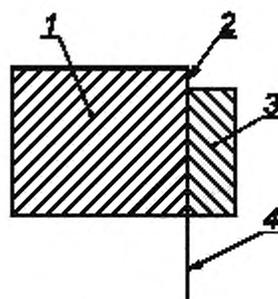
1 — рама; 2 — клей (закрепляет полиэстерную пленку); 3 — закрепленная шурупами внешняя накладка (прижимает пленку к слою клея); 4 — полиэстерная пленка
