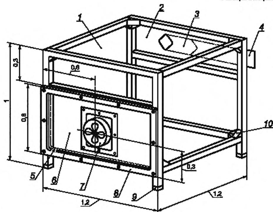
1 — полиэстерная пленка (покрыты все стороны каркаса, включая низ, кроме монтажной панели и выходного отверстия);
