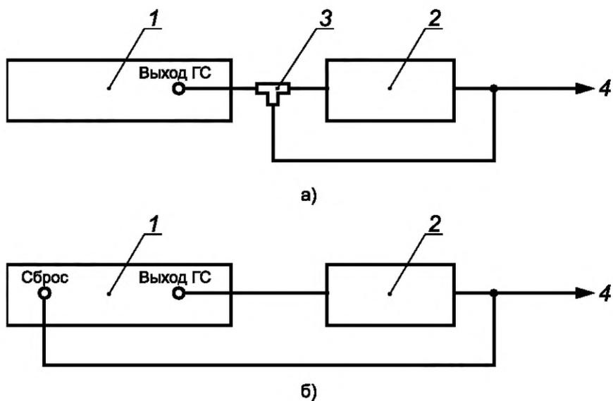
1 — поверяемый генератор; 2 — газоанализатор озона;
