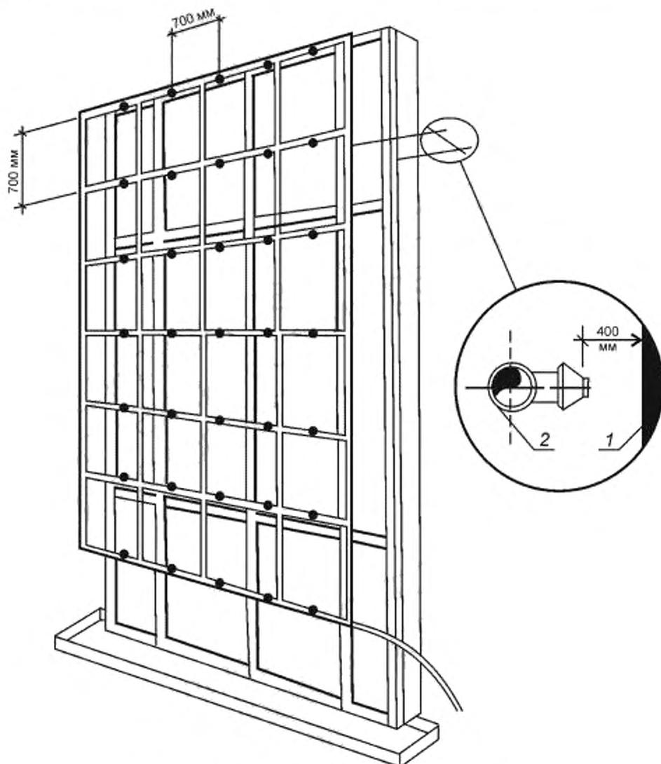
1 — образец для испытаний; 2 — форсунка дождевальной системы
