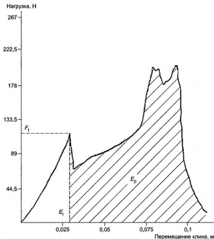
$F_i$  — нагрузка при зарождении разрушения;  $E_i$  — энергия зарождения разрушения;
