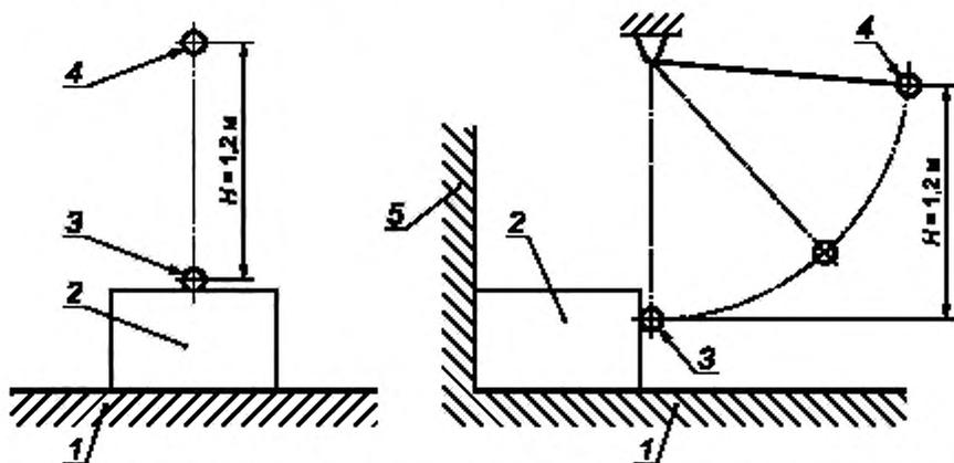
1 – жесткая опорная поверхность; 2 – испытательный образец; 3 – положение ударного элемента в момент удара;
