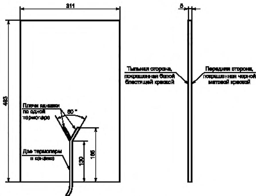
Рисунок 5 — Эталонная пластина (размеры в миллиметрах)
