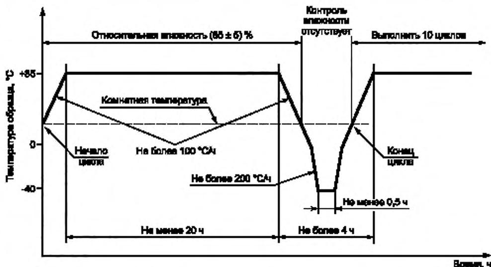
Рисунок 11 — Цикл термоциклирования при высокой влажности
