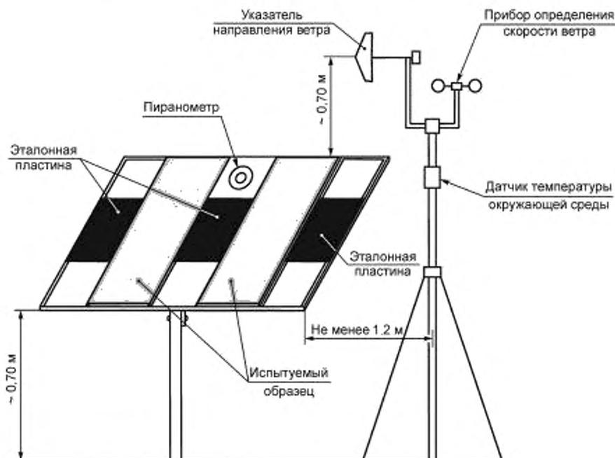
Рисунок 6 — Измерение НРТЭ методом эталонных пластин
