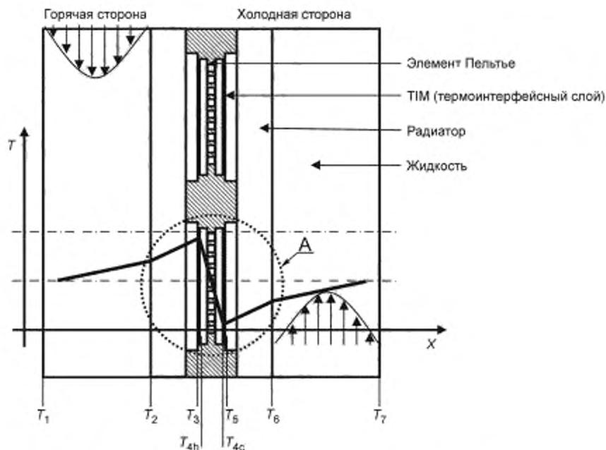
Рисунок 1, лист 1 — Принцип действия термоэлектрической системы охлаждения
