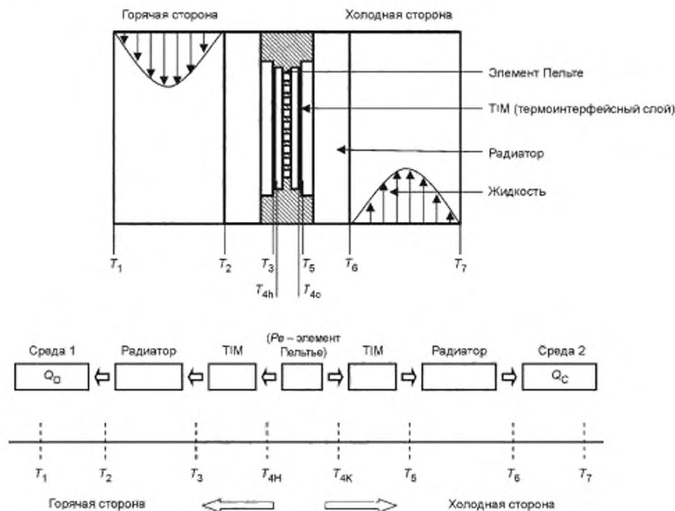
Рисунок А.6 — Тепловое сопротивление термoeлектрической системы охлаждения
