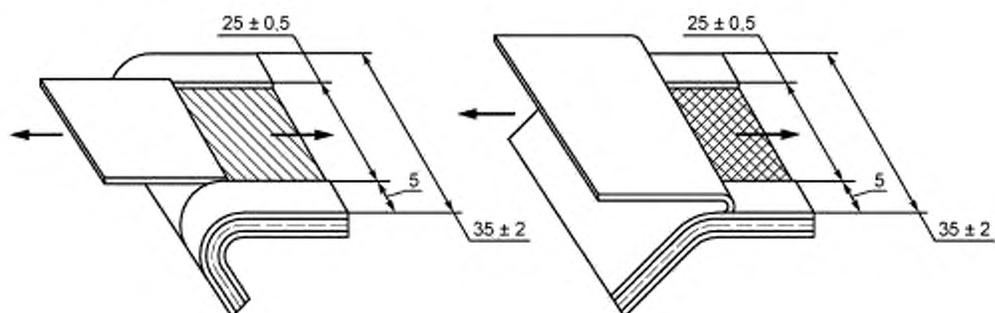
Рисунок 3 — Образец типа 3
