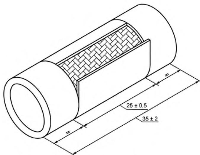
Рисунок 6 — Образец типа 6
