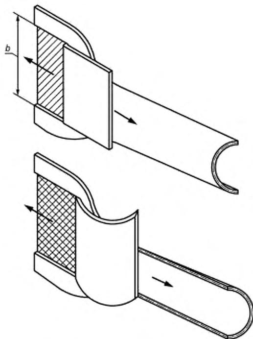
$b = (25,0 \pm 0,5) \text{ мм}, (10,0 \pm 0,5) \text{ мм или } (5,0 \pm 0,2) \text{ мм}$
