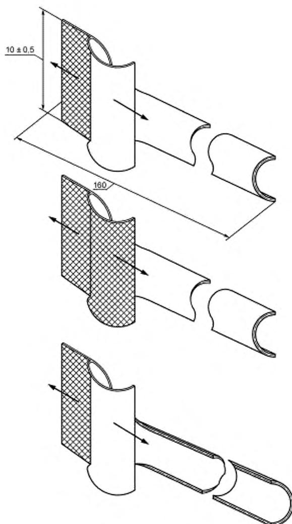
Рисунок 4 — Образец типа 4
