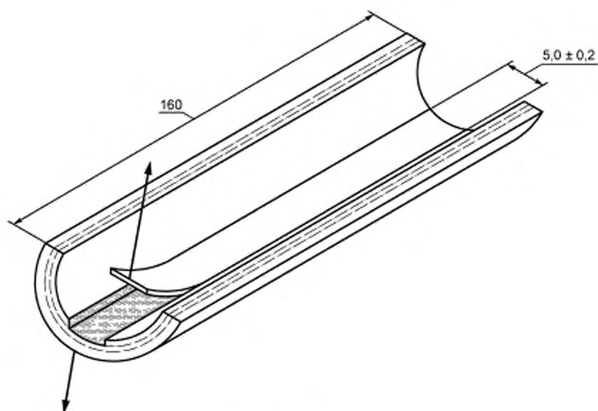
Рисунок 5 — Образец типа 5
