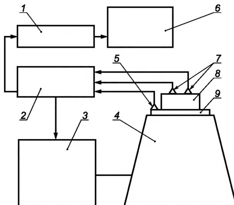
1 — персональный компьютер; 2 — цифровая система управления вибрационным воздействием (контроллер); 3 — усилитель мощности; 4 — вибрационная установка; 5 — вибропреобразователь в цепи обратной связи управления вибрационной установкой (устанавливается в контрольной точке); 6 — монитор; 7 — вибропреобразователи измерительные, устанавливаются на испытуемом изделии или крепежном приспособлении; 8 — испытуемое изделие; 9 — подвижный стол вибрационной установки.
