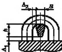
Рисунок 1 — Зацепка грузов крюками за строповочные элементы
