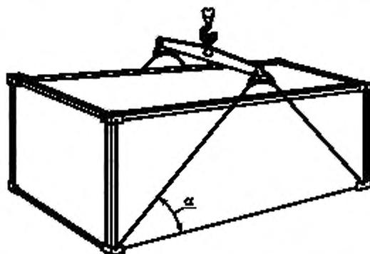
Рисунок 6 — Зацепка грузового контейнера линейной поперечной траверсой за нижние угловые фитинги
