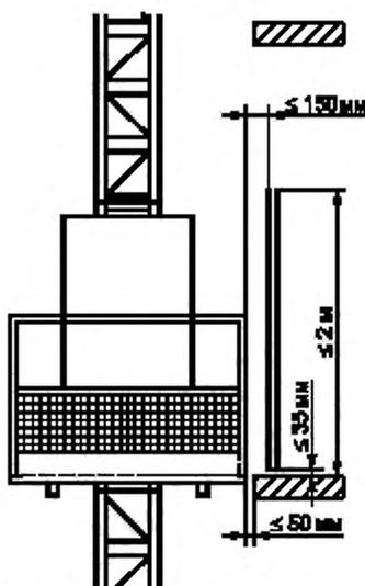
Рисунок 5 — Пример дверей погрузочной площадки в полную высоту
