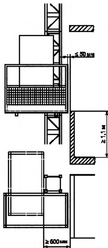
Рисунок 7 — Пример погрузочной площадки с неподвижным защитным устройством
