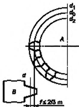
А — шестерня; В — рейка;  $d_1$  — диаметр окружности вершин зубьев шестерни;
