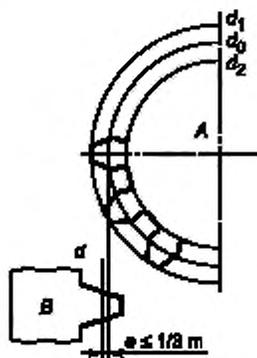
Рисунок 9 — Нормальное зацепление зуба шестерни
