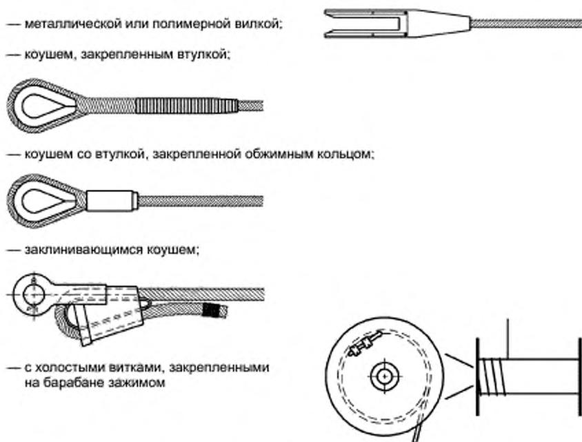
Рисунок 13 — Способы заделки концов проволочного каната
