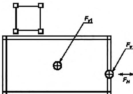
Рисунок 4 — Пример действия сил при загрузке и разгрузке
