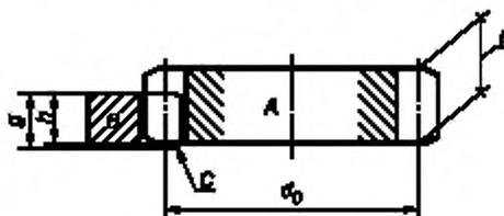
А — шестерня; В — рейка; С — фаска;  $d_0$  — диаметр делительной окружности шестерни;
