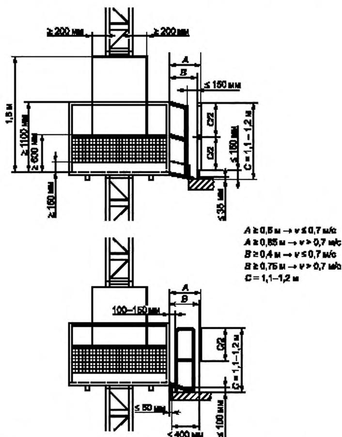
Рисунок 6 — Пример дверей погрузочной площадки уменьшенной высоты
