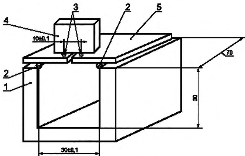
1 – основание для цилиндрических опор; 2 – опоры цилиндрические диаметром 3 мм; 3 – шарики диаметром 3 мм; 4 – нагружающий плунжер; 5 – образец материала в виде пластины с надрезом
