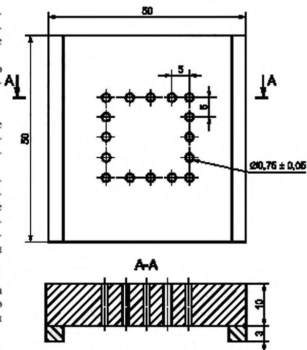
Рисунок 1 — Форма латунная перфорированная для проведения испытаний на пластичность базисных материалов при паковке
