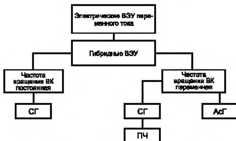
СГ – синхронный генератор; АсГ – асинхронизированный генератор; ПЧ – преобразователь частоты
