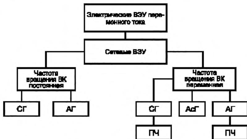
СГ — синхронный генератор; АГ — асинхронный генератор, АсГ — асинхронизированный генератор; ПЧ — преобразователь частоты
