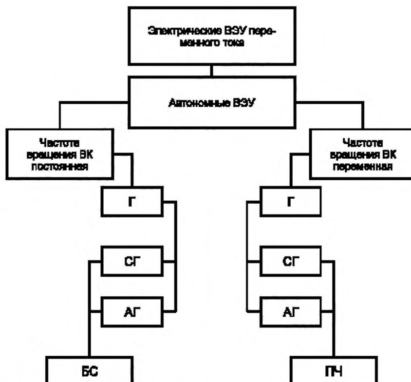
Г – генератор; СГ – синхронный генератор; АГ – асинхронный генератор; БС – балластное сопротивление; ПЧ – преобразователь частоты
