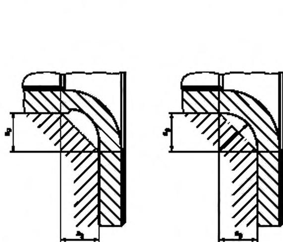
Рисунок 11 — Типы зоны перехода между радиальными частями
