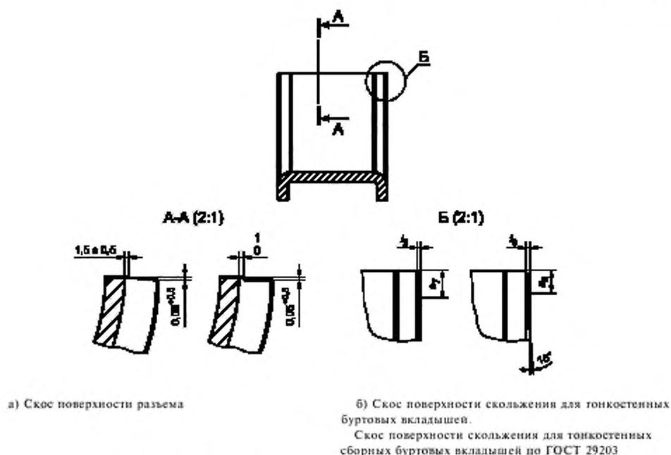
Рисунок 10 — Скосы бурта (конструкция по выбору изготовителя)
