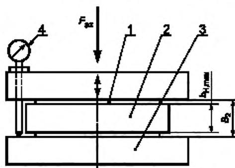
1 – сборный тонкостенный буртовый вкладыш; 2 – измерительный блок; 3 – неподвижная пластина; 4 – индикатор
