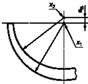
Рисунок 3 — Эксцентрическое отверстие тонкостенного гладкого или буртового вкладыша
