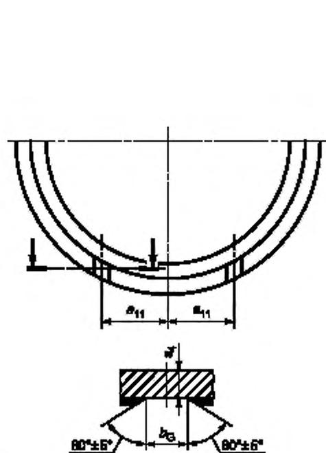
Рисунок 16 — Форма канавки на поверхности бурта
