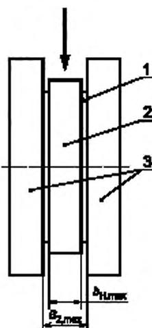
1 – цельный или сборный тонкостенный буртовый вкладыш; 2 – измерительный блок; 3 – неподвижные пластины
