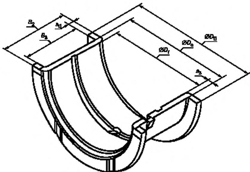
Рисунок 2 — Тонкостенный буртовый вкладыш (цельный или сборный, исключаяй распрямление)
