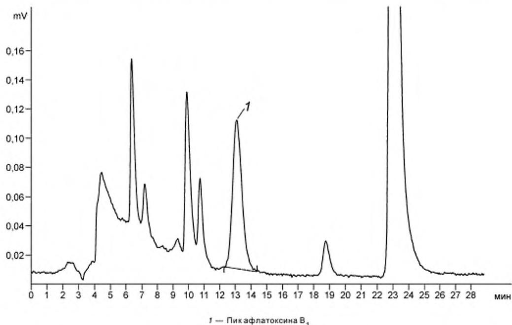
Рисунок Б.1 — Хроматограмма нерафинированного растительного масла с добавкой афлатоксина В<sub>1</sub>
