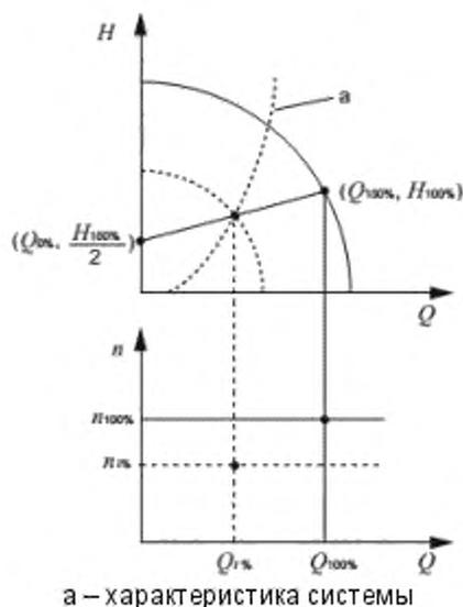
Рисунок 1 — Определение рабочей точки на режиме недогрузки
