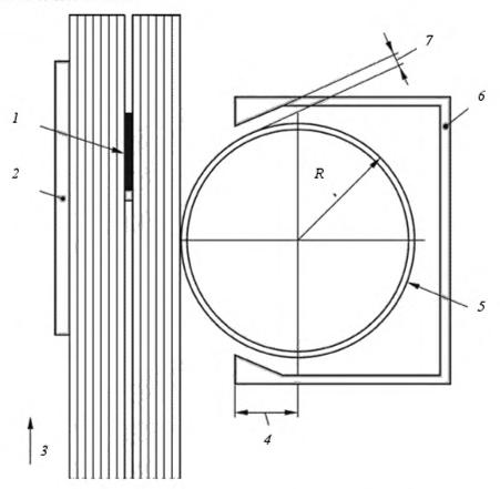
1 — полотно ленточной пилы; 2 — прижимная линейка; 3 — направление подачи обрабатываемой заготовки; 4 — меньше ½ R; 5 — ролик подачи; 6 — защитное ограждение; 7 — наибольший размер 4 мм
