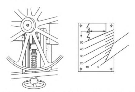
Рисунок 9 — Пример устройства для натяжения полотна ленточной пилы, маркировка, индикация
