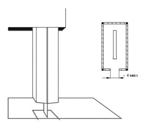
Рисунок 18 — Регулируемое защитное ограждение. Ленточнопильный станок со столом
