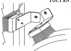
Рисунок 7 — Чистка полотна ленточной пилы и шкива ленточной пилы 5.3.2.3 Смазывание
