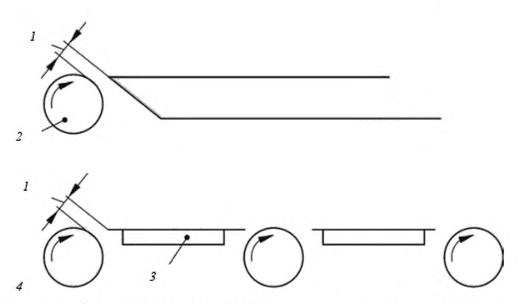
1 — раз мер 4 мм, наибольший зазор; 2 — ролики, приведенные в действие; 3 — стол рольганга
