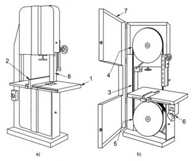
Таблица 1 — Обозначения и наименование узлов ленточнопильного станка со столом и ручной подачей
