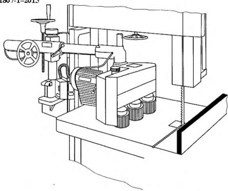
Рисунок 19 — Ленточнопильный станок со столом со съемным механизмом подачи
