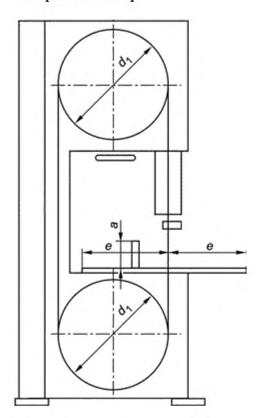
Рисунок 13— Наименьшие размеры стола. Высота и длина прижимной линейки
