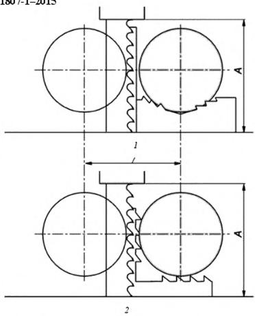
1 — наибольший подъем равен А+20 мм; 2 — А — наибольшая высота реза, для которой станок предназначен
