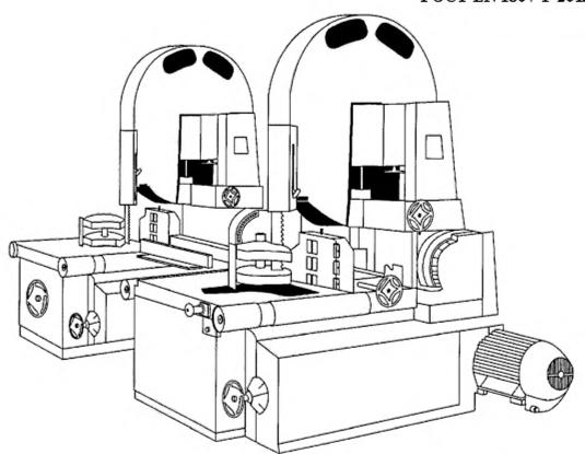
Рисунок 6 — Пример ленточнопильного делительного станка в исполнении тандема
