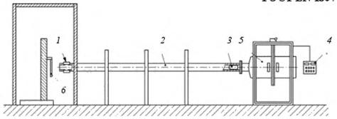
1 — измеритель скорости; 2 — ствол; 3 — перемещаемый «снаряд»; 4 — пульт управления; 5 — баллон сжатого воздуха; 6 — проверяемый объект Рисунок D.1 — Пример оборудования для проверки на ударную прочность
