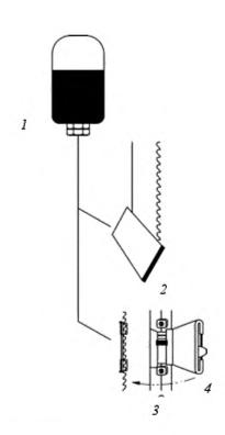
1 — устройство для подачи жидкости для смазки; 2 — приспособление для смазывания полотна пилы; 3 — устройство для чистки полотна пилы в открытой позиции; 4 — закрыто, во время чистки
