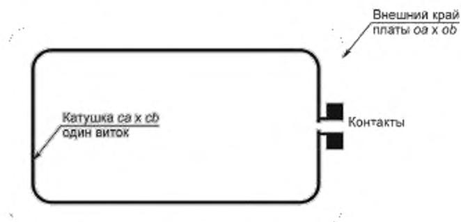
Рисунок 5 — Пример калибровочной катушки
