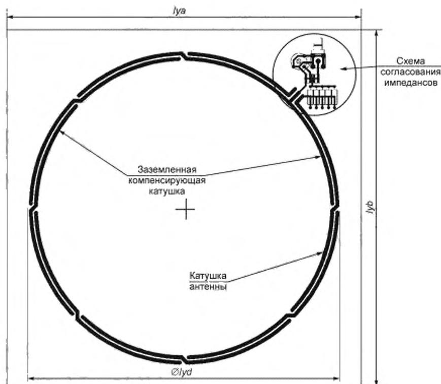
Эскиз выполнен без учета масштаба. Ширина дорожки контура рамки антенны  $l_{ya}$  (за исключением сквозных отверстий платы). Начиная с места размещения схемы согласования импеданса, через каждые  $45^\circ$  присутствуют сквозные переходы через плату. Печатная плата: двусторонняя с медным покрытием толщиной 45 мкм на основе из материала FR4 толщиной 1,8 мм.
