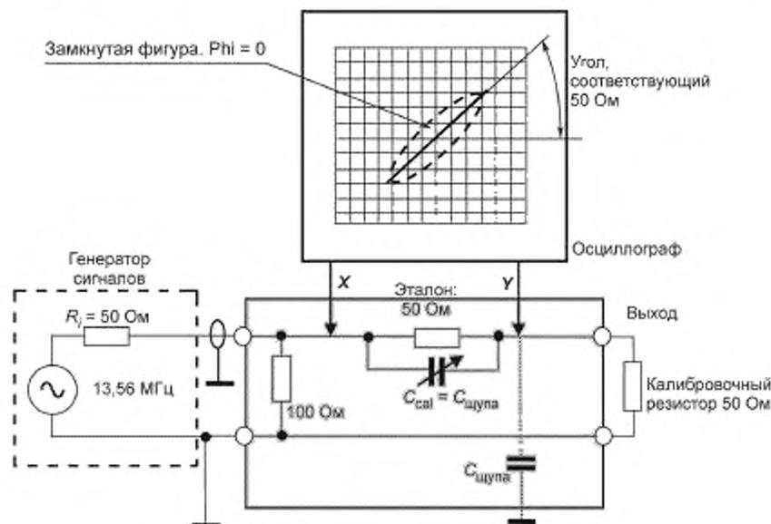
Рисунок D.1 — Предустановки при калибровке (этап 1)
