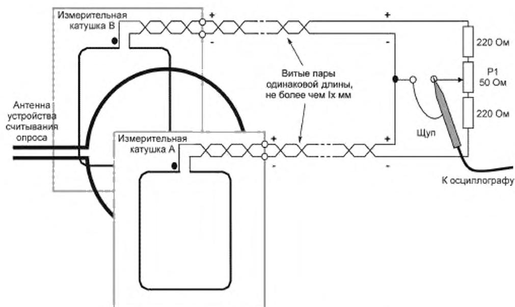
Рисунок 2 — Пример испытательной установки
