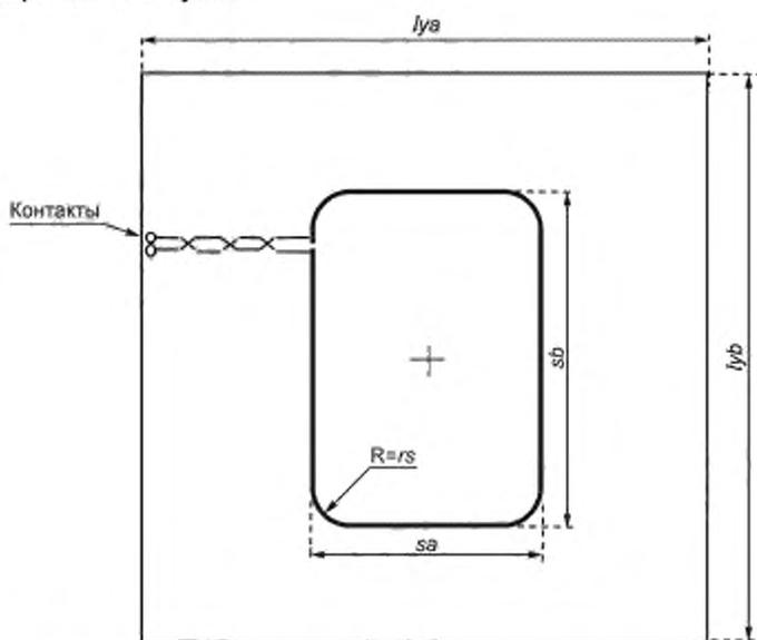
Рисунки приведены без учета масштаба. Ширина дорожки контура измерительной катушки  $0,5 \text{ мм} \pm 20 \%$  (за исключением сквозных отверстий платы). Размеры катушки зависят от внешних размеров радиочастотной метки. Печатная плата: двусторонняя с медным покрытием толщиной  $45 \text{ мкм}$  на основе из материала FR4 толщиной  $1,6 \text{ мм}$ .
