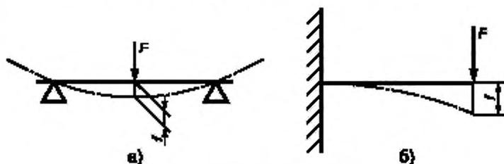
$F$  — испытательная нагрузка;  $f$  — значение деформации
