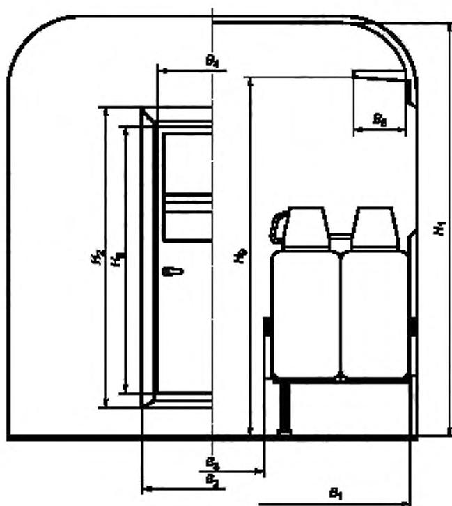
Параметр  $B_2$  измеряется на высоте 1500 мм от пола
