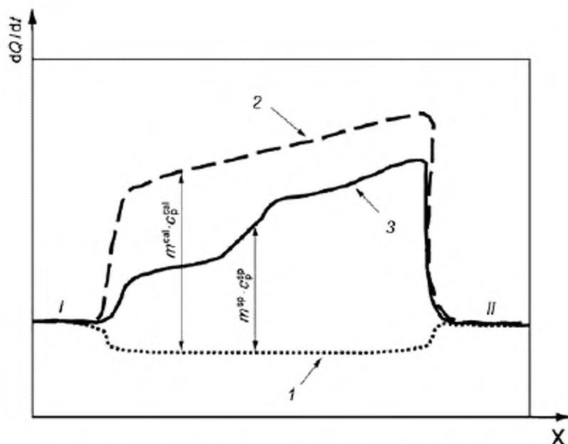
X — температура  $T$  или время  $t$ ; 1 — холостой опыт; 2 — калибровочный опыт; 3 — опыт с образцом;
