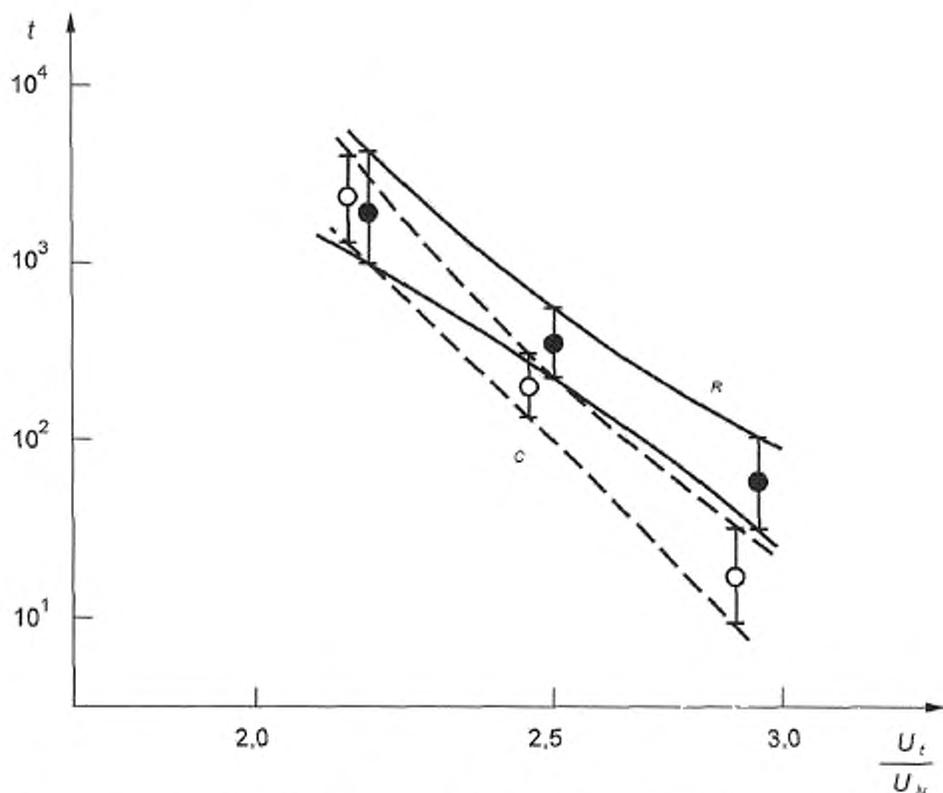
$R$  — данные старения эталонной системы изоляции ( $R$ ) с демонстрацией 90 % доверительного интервала;
