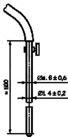
Рисунок 2 — Промывная трубка
