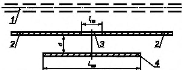
1 — железнодорожный путь; 2 — акустический экран; 3 — проем (разрыв) в акустическом экране;
