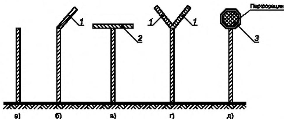
а) — без надстройки верхней граничной поверхности; б) — с надстройкой верхней граничной поверхности в виде односторонней полки (козырька), наклоненной в сторону железнодорожных путей; в) — с надстройкой верхней граничной поверхности в виде двухсторонней верхней полки (козырька) Т-образной формы; г) — с надстройкой верхней граничной поверхности в виде двухсторонней верхней полки (козырька) Y-образной формы; д) — в виде протяженной звукопоглощающей конструкции
