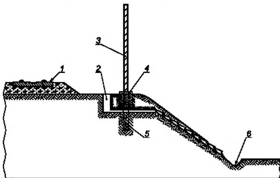
1 — железнодорожный путь, 2 — водосток, 3 — акустический экран; 4 — бетонное основание;
