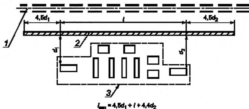
1 — железнодорожный путь; 2 — акустический экран; 3 — объект защиты;  $d_1$ ,  $d_2$  — расстояния от крайних объектов защиты до акустического экрана, м;  $l_{\text{экp}}$  — общая длина акустического экрана
