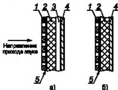
1 — перфорированный лист (звукопрозрачная сетка); 2 — звукопоглощающий материал (50—100 мм); 3 — воздушный промежуток (50—80 мм); 4 — твердый сплошной лист; 5 — стеклоткань Э-0,1 или пленка толщиной не более 50 мкм
