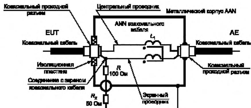
АЕ — оборудование, связанное с основным; EUT — испытуемое оборудование;  $R_2$  — входное полное сопротивление приемника; катушка индуктивности асимметричного режима  $L_1 = 2 \times 7$  мГн
