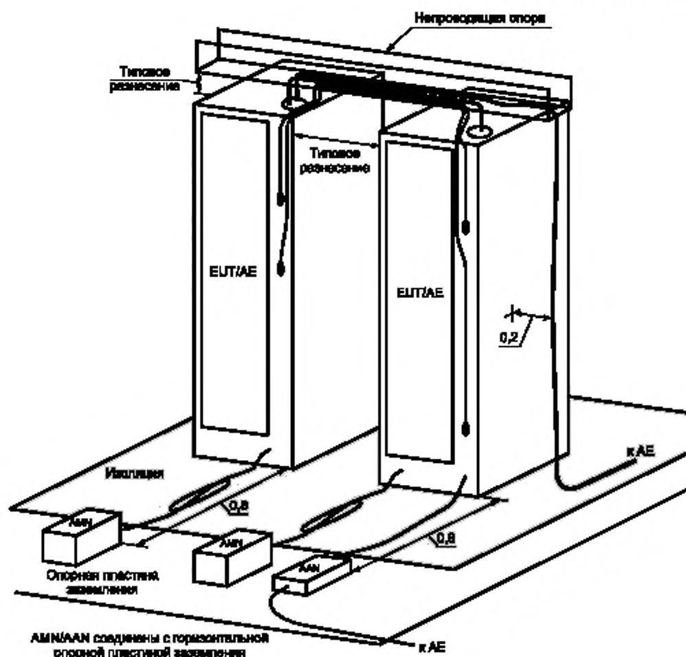
D.6 — Пример схемы измерения напольного EUT
