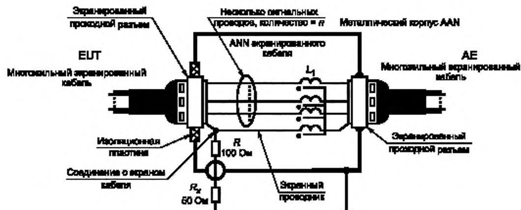
АЕ — оборудование, связанное с основным; EUT — испытуемое оборудование;  $R_x$  — входное полное сопротивление приемника; катушка индуктивности асимметричного режима  $L_1 = (n + 1) \times 7$  мГн, где  $n$  — количество сигнальных проводов
