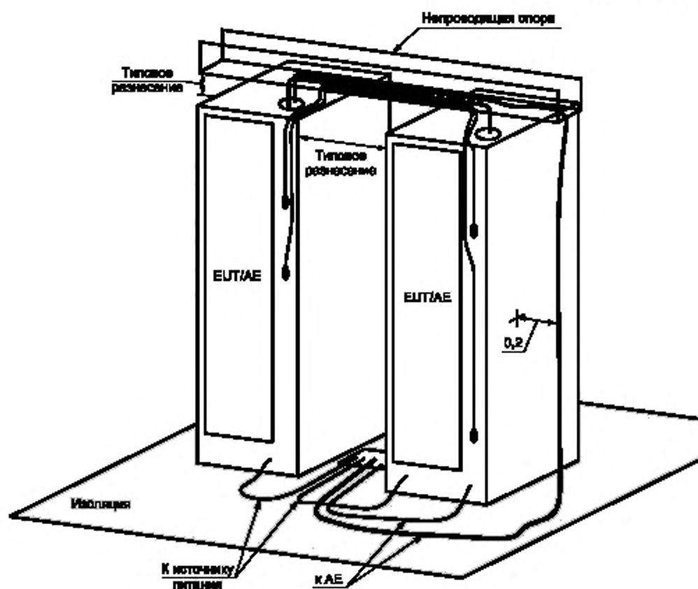
Рисунок D.9 — Пример схемы измерения напольного EUT
