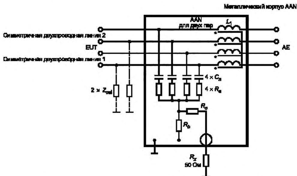
$C_x = 33$  нФ;  $R_n = 576$  Ом;  $R_b = 6$  Ом;  $R_0 = 44$  Ом;  $L_1 = 4 \times 7$  мГн; AE — оборудование, связанное с основным, EUT — испытуемое оборудование;  $R_x$  — входное полное сопротивление приемника
