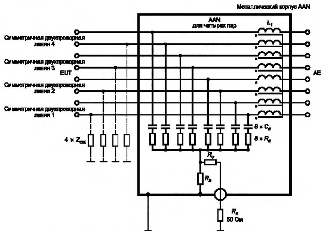
$C_g = 33$  пФ;  $R_g = 1152$  кОм;  $R_b = 6$  Ом;  $R_v = 44$  Ом;  $L_1 = 8 \times 7$  мГн; AE — оборудование, связанное с основным;
