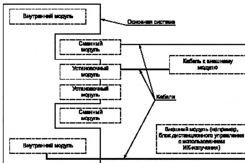
Рисунок 2 — Пример основной системы с модулями разных типов
