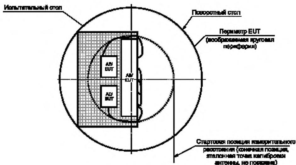
Рисунок С.2 — Периметр EUT, местного АЕ с соответствующей прокладкой кабелей
