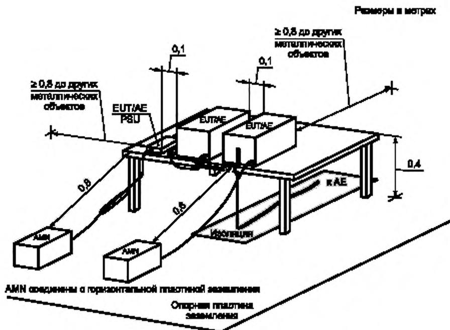
**Примечание** — Расстояние 0,8 м, указанное между EUT/мастным AEP/BU и AMN, относится к EUT. Если устройством является AE, расстояние должно быть  $\geq 0,8$  м.
