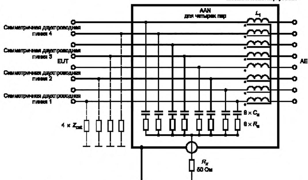
$C_0 = 33$  пФ,  $R_0 = 800$  Ом;  $L_1 = 8 \times 7$  мГн; AE — оборудование, связанное с основным; EUT — испытуемое оборудование;
