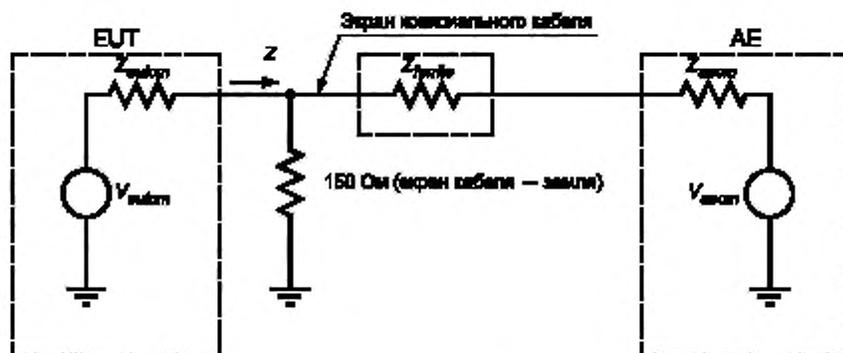
$V_{EUT}$  — общее несимметричное напряжение, создаваемое EUT;  $Z_{EUT}$  — общее несимметричное полное сопротивление источника EUT;  $V_{AE}$  — общее несимметричное напряжение, создаваемое АЕ;  $Z_{AE}$  — общее несимметричное полное сопротивление источника АЕ;  $Z_{ferite}$  — полное сопротивление ферритов
