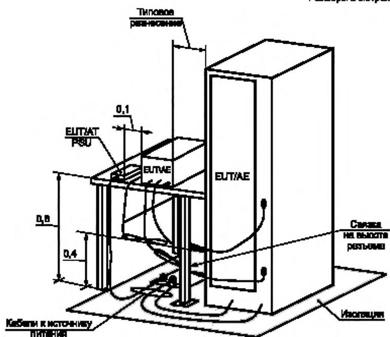
Рисунок D.10 — Пример схемы измерения комбинаций EUT
