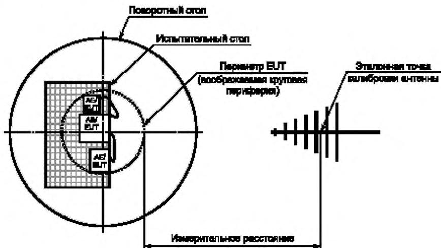
Рисунок С.1 — Измерительное расстояние
