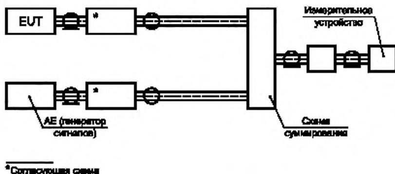
Рисунок С.7 — Компонка схемы измерения напряжения эмиссии на портах тюнера ТВ/ЧМ-приемников
