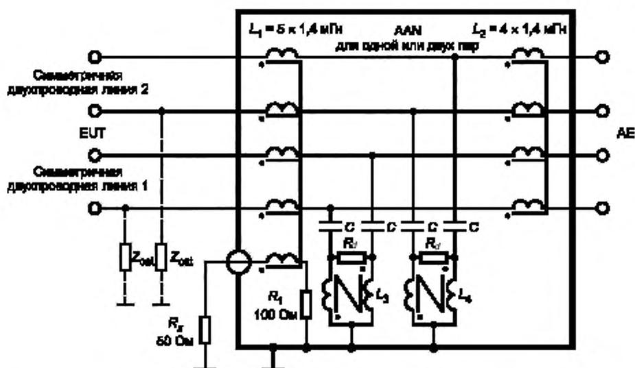
$C = 82$  пФ;  $L_3 = 2 \times 3,1$  мГн;  $L_4 = 2 \times 3,1$  мГн,  $R_g = 390$  Ом; АЕ — оборудование, связанное с основным;
