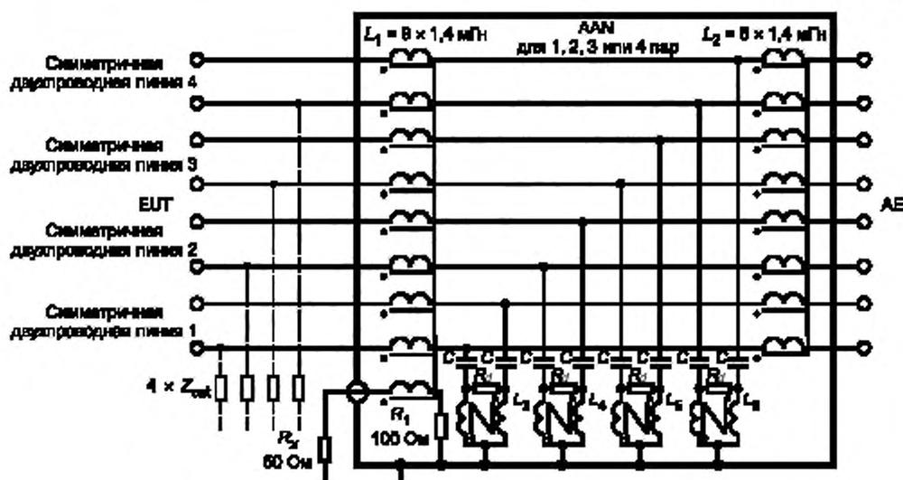
$C = 82$  пФ;  $R_2 = 390$  Ом; AE — оборудование, связанное с основным; EUT — испытуемое оборудование,
