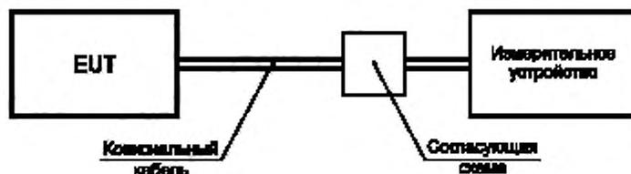
Рисунок С.8 — Компонка схемы измерения полезного сигнала и напряжения электромагнитной эмиссии на выходном порте ВЧ-модулятора EUT
