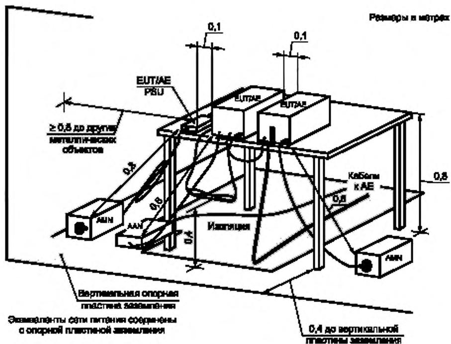
**PSU** — блок питания (включая преобразователь питания «переменный ток/постоянный ток».
