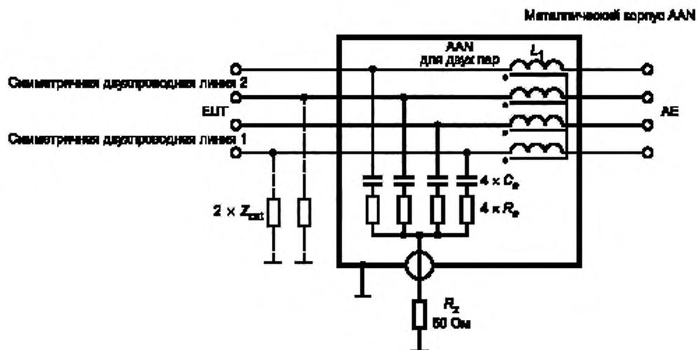
$C_x = 33 \text{ нФ}$ ;  $R_x = 400 \text{ Ом}$ ;  $L_1 = 4 \times 7 \text{ мГн}$ ;  $AE$  — оборудование, связанное с основным;  $EUT$  — испытуемое оборудование;
