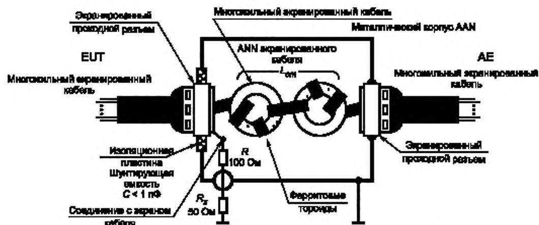
АЕ — оборудование, связанное с основным; EUT — испытуемое оборудование;  $R_x$  — входное полное сопротивление приемника; катушка индуктивности асимметричного режима  $L_{om} > 9$  мГн, полная паразитная шунтирующая емкость  $C < 1$  пФ
