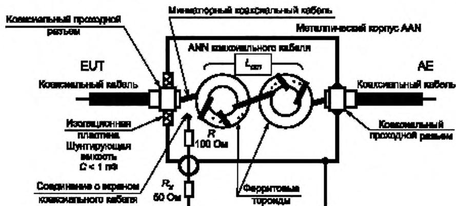
АЕ — оборудование, связанное с основным; EUT — испытуемое оборудование;  $R_2$  — входное полное сопротивление приемника; катушка индуктивности асимметричного режима  $L_{cm} > 9$  мГн, полная паразитная шунтирующая емкость  $C < 1$  пФ
