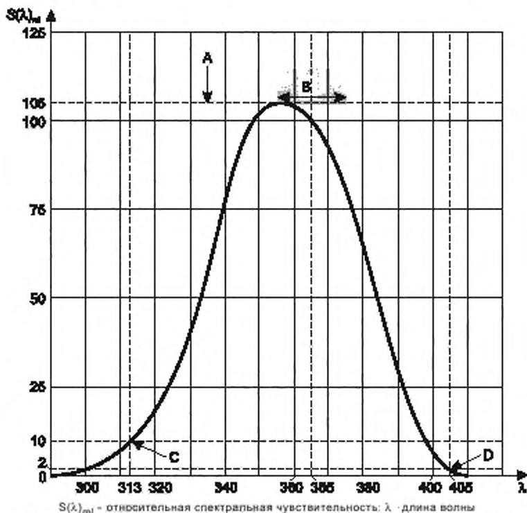
Рисунок 1 – Спектральная чувствительность измерителей УФ-А-излучения
