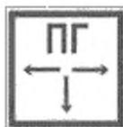
Рисунок Б.3 — Пожарный гидрант
