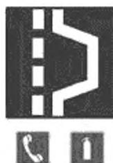
Рисунок Б.4 — Площадка для аварийной остановки
