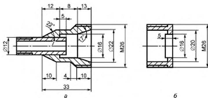
а — корпус; б — накидная гайка
