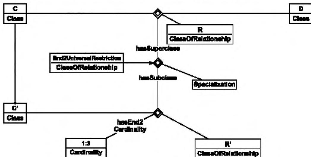
Рисунок 25 — Комбинирование универсальных ограничений и кардинальных чисел
