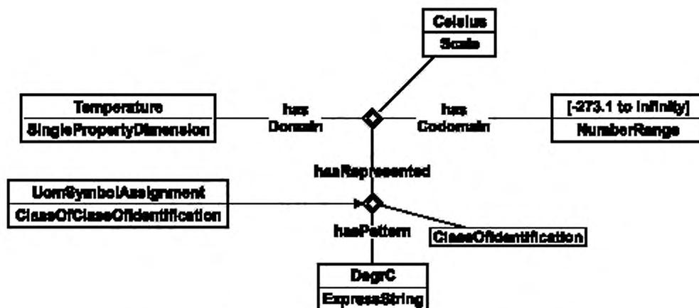
Рисунок 45 — Пример шаблона DimensionUnitNumberRangeOfScale
