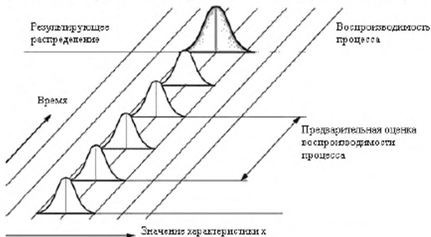
Рисунок 5 – Стабильный процесс и его воспроизводимость
