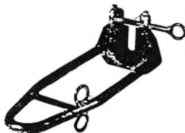
10.2.5 **кольцевой зажим со скобой (wire tong stirrup):** Металлическое устройство, установленное на поддерживающей штанге, чтобы обеспечить точку привязи или точку крепления.
