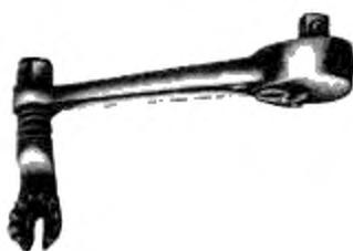
4.3.10 **гаечный ключ** (spanner wrench): Съёмный инструмент, предназначенный для завинчивания или отвинчивания гаек и болтов.
