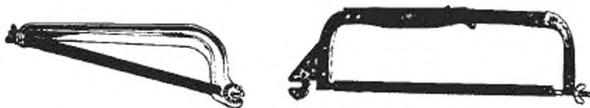
4.3.36 **садовая пила** (pruning saw): Съёмный инструмент, предназначенный для резки древесных сучьев.
