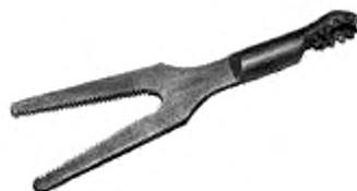
4.3.16 **насадка двууголая** (fixed double-prong head): Съёмный инструмент, предназначенный для работы с вязальной проволокой или оборудованием.
