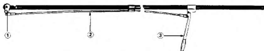
1 -- режущая головка; 2 -- тяга; 3 -- рычаг управления
