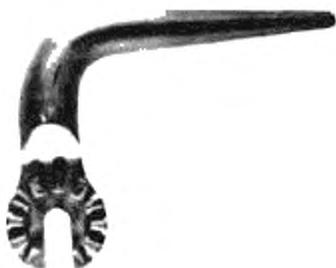
4.3.6 **щетка для чистки провода (conductor cleaning brush)**: Съёмный инструмент, предназначенный для очистки проводов.
