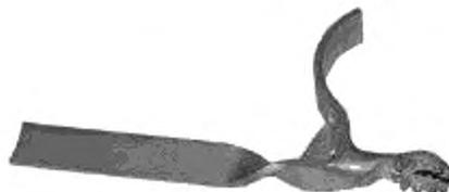
4.3.19 **резак вязальной проволоки** (binding wire cutter blade, tie wire cutter): Съёмный инструмент, предназначенный для перемещения или резки вязальной проволоки.
