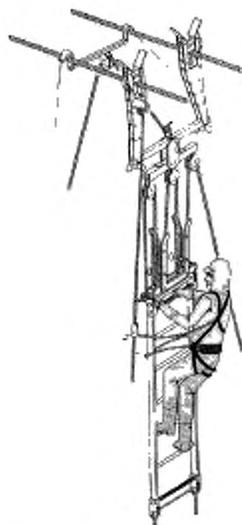
9.1.16 **Проводная тележка** (conductor car): Тележка, подвешенная к проводу(ам), отстраненная от проводника(ов) и предназначенная для использования в качестве рабочей платформы.
