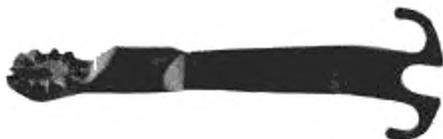
4.3.23 **молоток** (hammer): Съёмный инструмент, предназначенный для нанесения удара по оборудованию, когда это необходимо.
