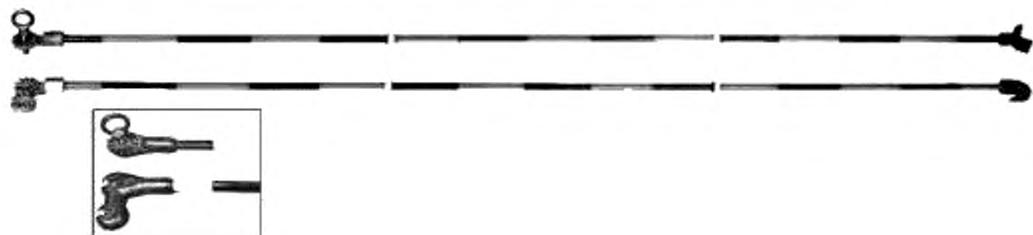
**11.2.5 телескопическая измерительная штанга (telescopic measuring stick):** Измерительная оперативная штанга, состоящая из нескольких диэлектрических секций, образующих раздвижную конструкцию.
