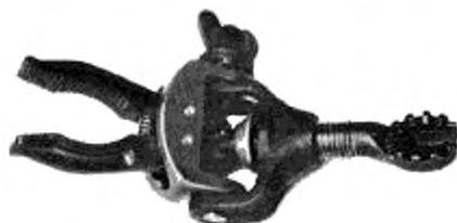
4.3.30 **держатель штифта** (pin holder): Съёмный инструмент, предназначенный для удерживания штифта или болта.
