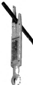
11.2.3 **калибр зазора (gap gauge)**: Диагностическое устройство из изоляционного материала, установленное на универсальной ручной штанге и предназначенное для контроля и установки искрового промежуточного рогового разрядника.
