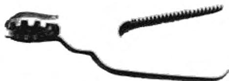
4.3.11 **насадка с зажимом** (positive grip clamp stick head): Съёмное устройство, предназначенное для удерживания любых компонентов, оснащенных проушиной.
