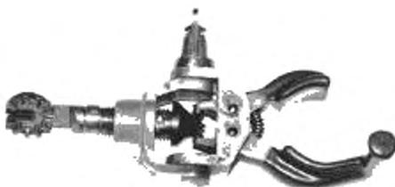
4.3.25 **винтовой захват** (screw clamp): Съёмное устройство с регулируемыми губками, предназначенное для захвата и удержания головки изолятора.
