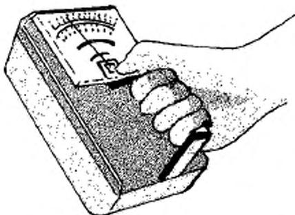
**11.3.6 указатель напряжения (voltage detector):** Диагностический прибор, предназначенный для подтверждения факта наличия или отсутствия рабочего напряжения.
