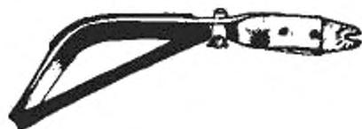
4.3.39 **зеркало** (mirror): Съёмный инструмент, предназначенный для осмотра скрытых от визуального наблюдения частей.
