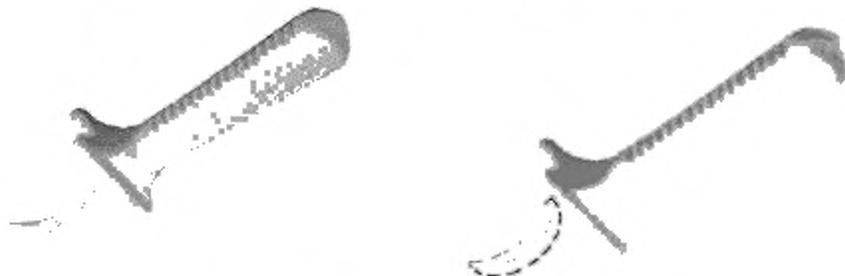
7.4.6 **гибридный торцевой гаечный ключ** (hybrid socket wrench): Гибридный ручной инструмент с металлической вставкой, выполненный в виде отвертки, предназначенный для завинчивания или отвинчивания винтов, болтов и гаек.
