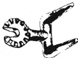
4.3.17 **установщик стопорного штифта** (retaining pin installer): Съёмный инструмент, предназначенный для установки стопорных штифтов (шплинтов, клиньев), пружинных замков к изолятору или аналогичных фиксирующих устройств.
