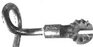
4.3.35 **ножовка** (hacksaw): Съёмный инструмент, предназначенный для распиливания какой-либо металлической части.
