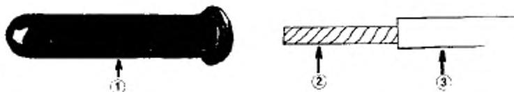
1 — колпачок; 2 — оголенный провод; 3 — изоляции
