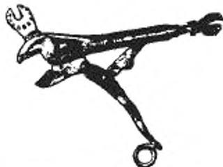
4.3.28 **хомут для работы с изолированными подвесками** (adjustable insulator fork): Съёмное устройство, предназначенное для удержания изоляторов во время их установки или демонтажа.
