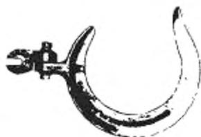
4.3.13 **экстрактор стопорного штифта** (retaining pin extractor): Съёмный инструмент, предназначенный для извлечения стопорных штифтов из фитингов и крепежных изделий.
