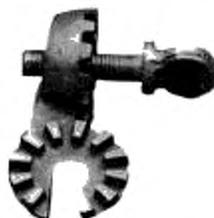
**4.3.4 кольцо — формирователь проволоки (formed-wire ring):** Съемный инструмент, предназначенный для установки или удаления витой или предварительно отформованной вязальной проволоки.
