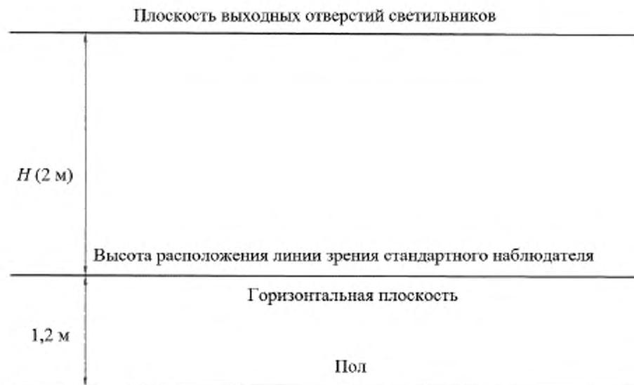
Рисунок 4 — Размеры стандартного модуля в разрезе
