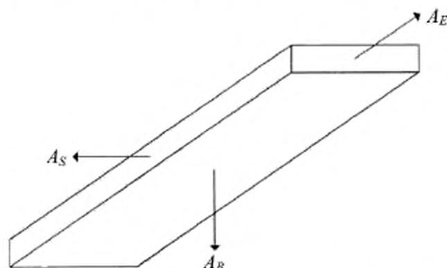
Рисунок 2 — Расположение светящихся поверхностей светильника, видимых стандартному наблюдателю
