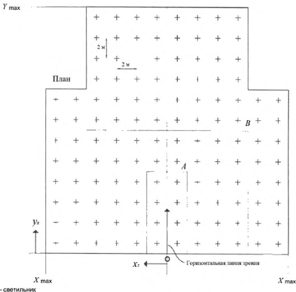
Рисунок 3 — Стандартное расположение светильников в плане по [3] (площадь  $A$  соответствует размерам  $2H \times 4H$ , площадь  $B$  соответствует размерам  $8H \times 6H$ )
