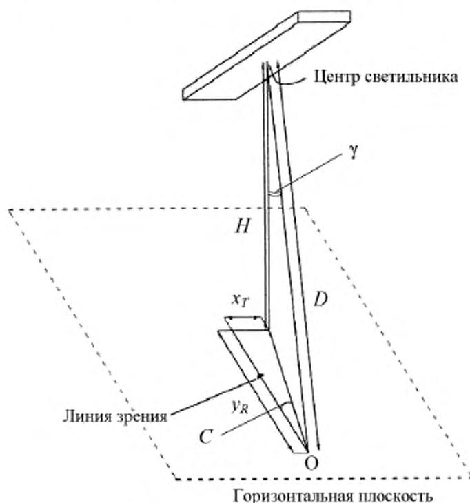
Рисунок 1 — Расположение центра светильника относительно стандартного наблюдателя по [3]
