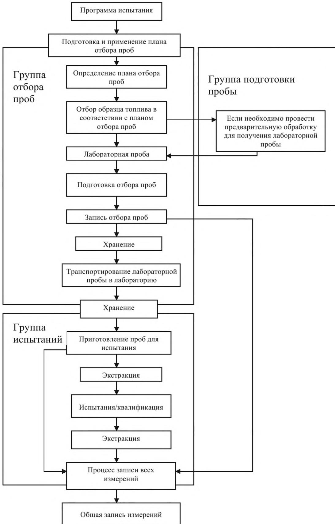
Рисунок 1 — Связи между существенными элементами программы испытания
