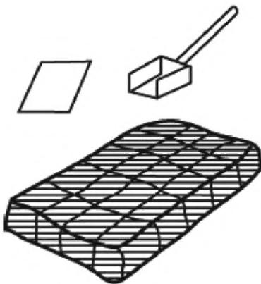
в) Зачерпывание случайных проб из каждой из 20 частей, совок вставляют до дна слоя пробы. Объединяют 20 зачерпов в отдельную пробу
