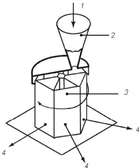
1 — подающий механизм; 2 — воронка; 3 — вращающийся приемник; 4 — разделитель проб
