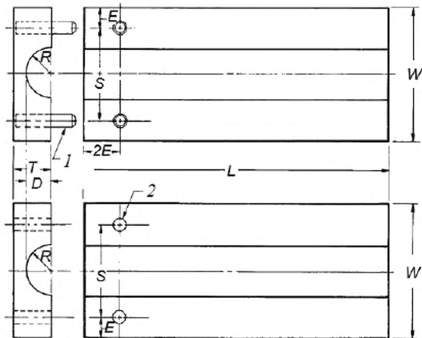
1 – штифт; 2 – отверстие;  $T$  – толщина пластины адаптера для захватов;  $D$  – радиус паза;  $R$  – радиус образца;  $E$  – расстояние от края адаптера для захватов до центра отверстия для штифта;  $S$  – расстояние между центрами отверстий для штифтов;  $L$  – длина адаптера для захватов;  $W$  – ширина адаптера для захватов
