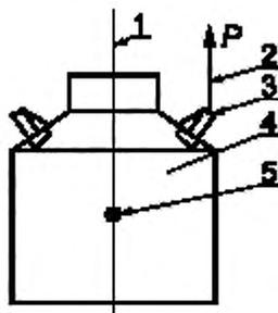
1 — вертикальная ось тары; 2 — направление усилия, прилагаемого к ручке тары; 3 — испытываемая ручка; 4 — испытываемая тара; 5 — центр тяжести испытываемой тары
