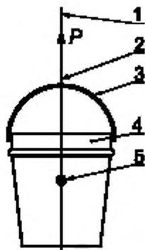
1 — линия, проходящая через центр тяжести по вертикальной оси тары; 2 — направление прилагаемого усилия к ручке тары; 3 — испытываемая ручка тары; 4 — испытываемая тара; 5 — центр тяжести испытываемой тары
