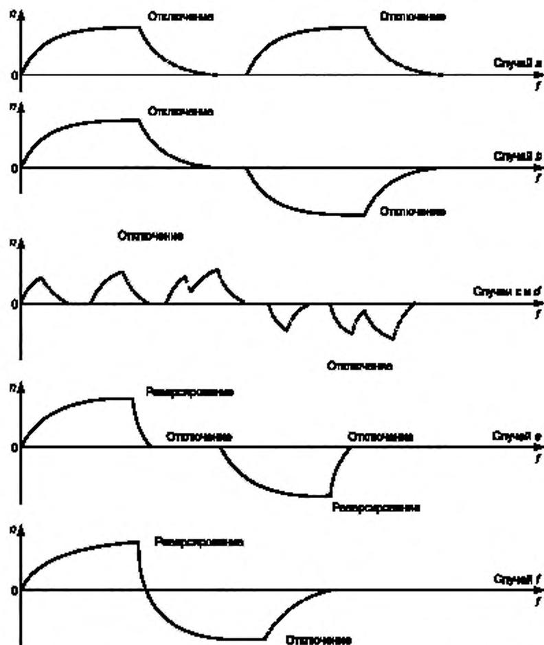
Рисунок 6 — Примеры кривых скорость — время, соответствующие случаям а)–в) по 4.3.5.5 (пунктирные участки кривых обозначают периоды обесточивания двигателя)
