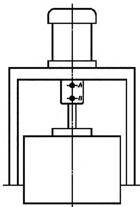
Рисунок 3 — Точки измерения вибрации для подвесных центрифуг
