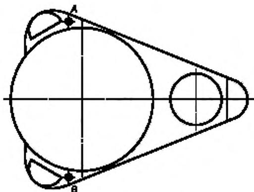
Рисунок 5 — Точки измерения вибрации для маятниковых центрифуг
