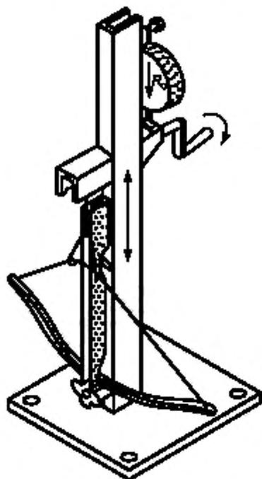
Рисунок 2 — Схема измерения силы дуг (дуги) арбалета
