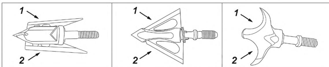
1 и 2 — режущие кромки наконечника
