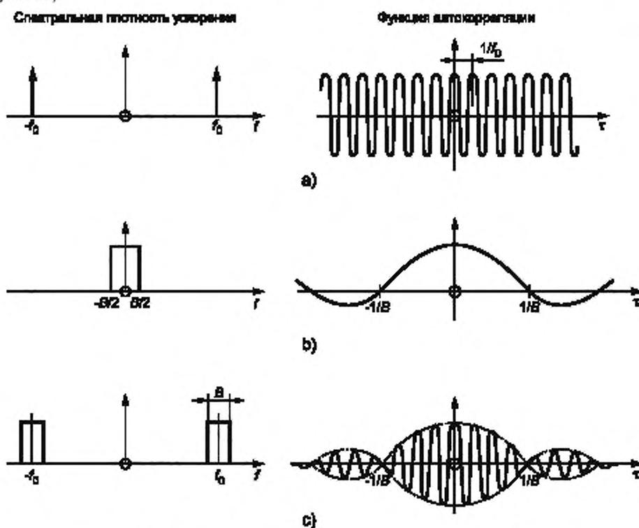
Рисунок 3 — Функции автокорреляции разных сигналов<sup>1)</sup>
