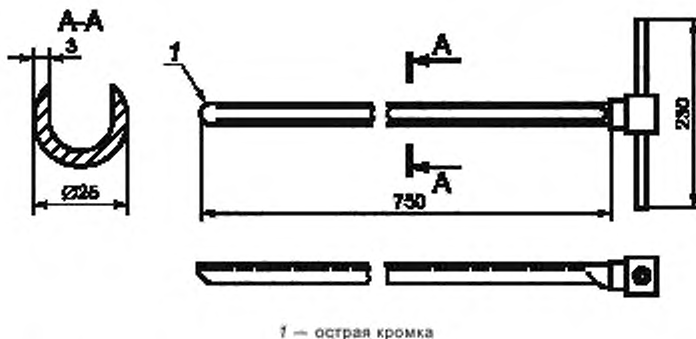
Рисунок 2 — Пробоотборник открытого типа — типичные размеры
