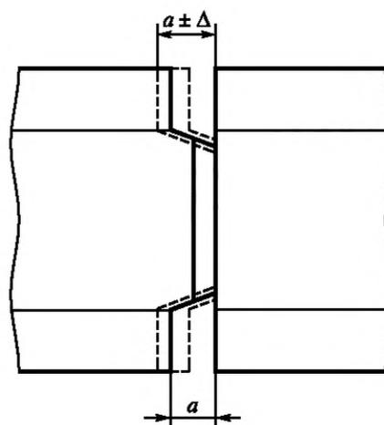
$a$  — ширина зазора по клеевому соединению ящика
