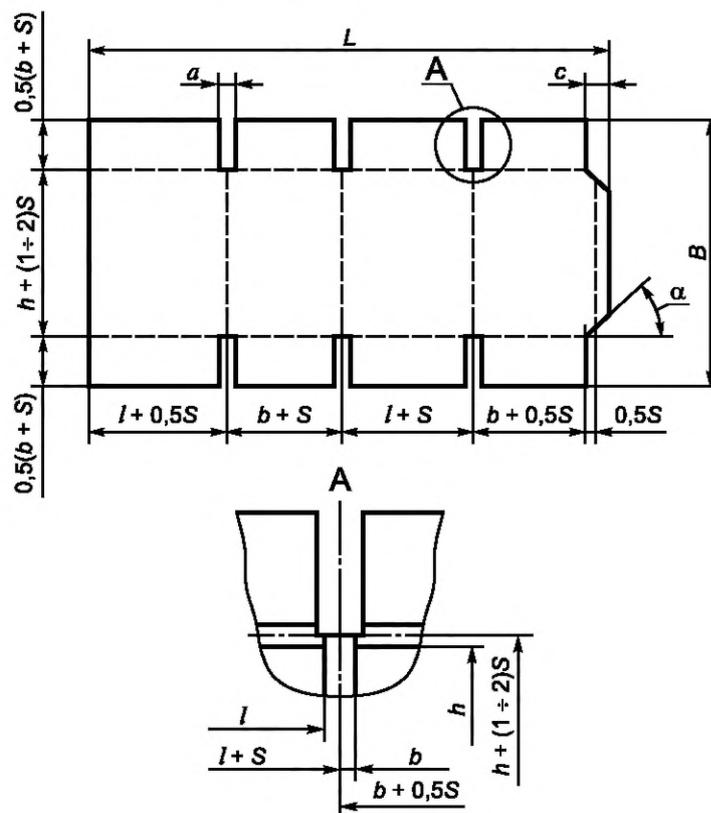
$L$  — длина развертки, мм;  $B$  — ширина развертки, мм;  $l$ ,  $b$ ,  $h$  — внутренние размеры ящика (длина, ширина, высота), мм;
