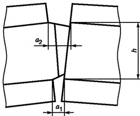
$a_1$  — ширина зазора по клеевому соединению ящика, измеренная снизу;
