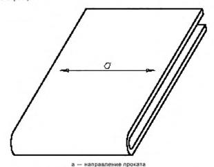
Рисунок А.1 — Испытания на изгиб
