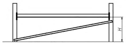
Рисунок 22а, вариант 1: Узлы крепления раскоса не совпадают с узлами крепления балки
