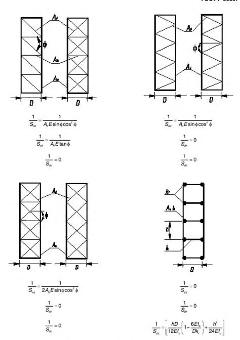
Рисунок G.2 — Жесткость рамы при действии поперечной силы
