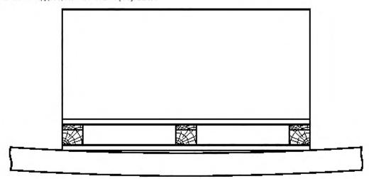
Рисунок 16 — Нагрузка, передающаяся через два наружных элемента поддона (шашки)
