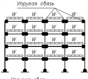
В.1а — Расчетная схема нагружения
