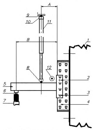
1 — рама испытательной установки; 2 — фиксатор балки; 3 — зацеп кронштейна балки; 4 — стойка; 5 — балка; 6 — роликовая опора; 7 — регулируемая опора, 8 — щарнирная опора, 9 — шарнирная опора; 10 — датчик нагрузки; 11 — шток гидроцилиндра испытательной установки; 12 — направление действия горизонтальной нагрузки; А — минимально возможное расстояние от штока гидроцилиндра испытательной установки до стойки; В ≥ 400 мм;
