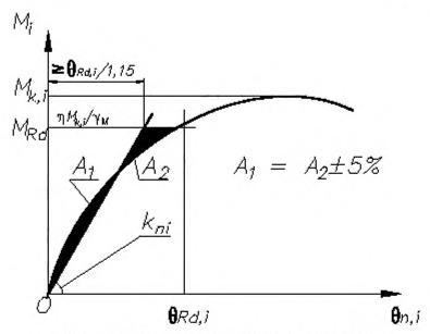
Рисунок. A.6 — Обработка значений жесткости кронштейна балки
