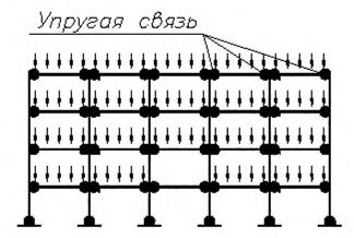
27а — Расчетная схема нагружения стеллажа без крестовых раскосов жесткости
