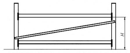
Рисунок 22с, вариант 3: Нижняя балка или узел примыкания раскоса находится близко к полу
