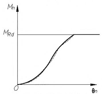
Рисунок А.8 — Типовая линеаризация средней кривой
