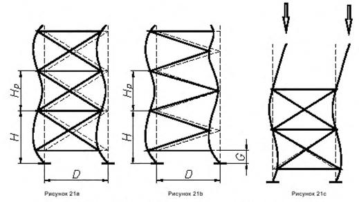
D — расстояние между стойками в раме; G — эксцентриситет; H — высота уровня;  $H_0$  — наибольшая длина стержня между узлами крепления раскосов
