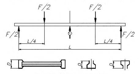
Рисунок. А.15 — Порядок проведения испытаний
