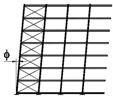
Рисунок 8 — Общие отклонения от вертикальной плоскости
