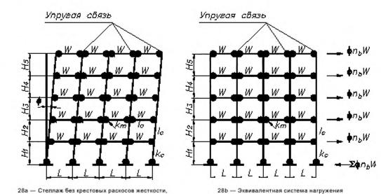
Рисунок 28 — Расчетная схема конструкции степлажа без крестовых раскосов жесткости для оценки устойчивости в *X*-направлении
