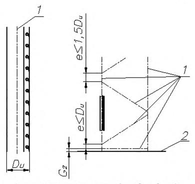
t — центральные оси конструктивных элементов; 2 — пол;  $D_u$  — глубина стойки e — эксцентриситет между раскосами;  $G_2$  — расстояние от пола до нижней точки узла раскоса
