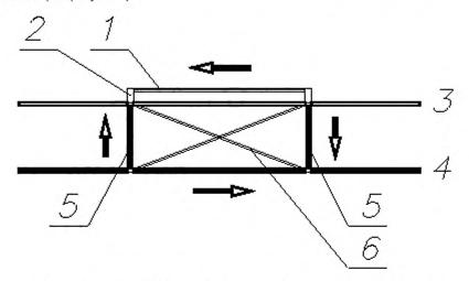
1 — вертикальные раскосы жесткости; 2 — кронштейны вертикальных раскосов жесткости; 3 — задняя плоскость степлажа; 4 — передняя плоскость степлажа;
