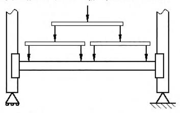
Рисунок A.16 — Пример моделирования нагрузки при испытаниях балок
