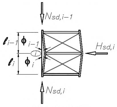
Рисунок 9 — Местные отклонения раскосной системы
