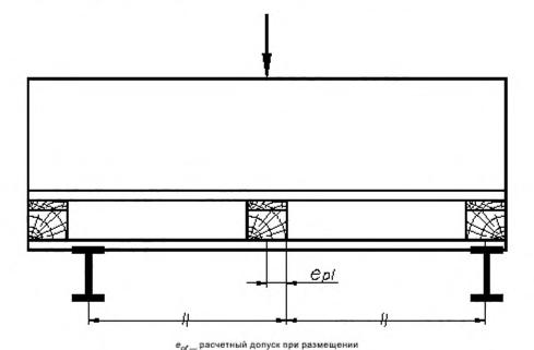
Рисунок Е.1 — Эксцентриситет нагрузки
