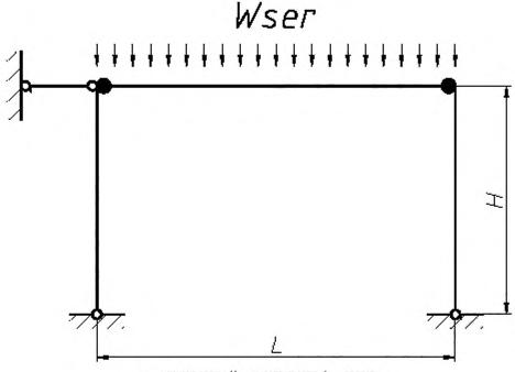
• — упругая связь; H — высота уровня; L — пролет;  $W_{\mathsf{sor}}$  — нормативная нагрузка для расчета по предельному состоянию эксплуатационной пригодности
