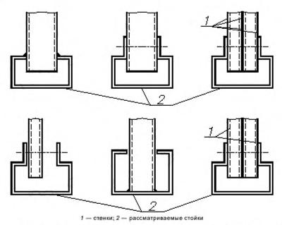
Рисунок 24 — Примеры соединений раскосов (а — верхний ряд — с полным закреплением от кручения и депланации; b — нижний ряд — с частичным закреплением от кручения и депланации)
