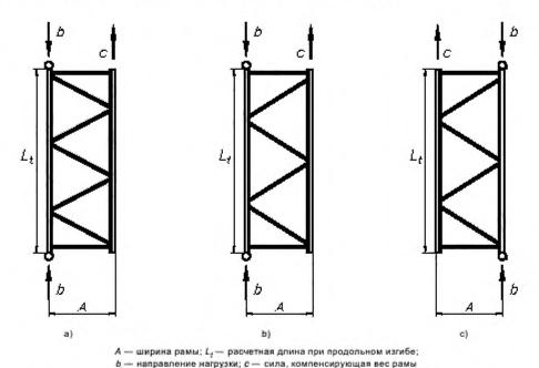
Рисунок А.3 — Порядок альтернативного проведения испытаний стоек на сжатие
