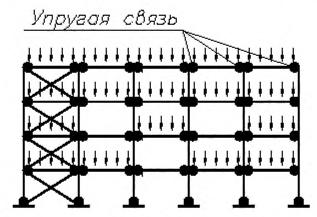
27b — Расчетная схема нагружения степлажа с крестовыми раскосами жесткости
