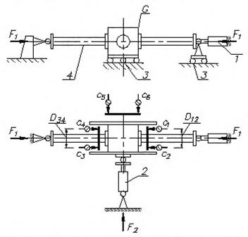
f и 2 — нагружающие устройства; 3 — родиковый подшилник; 4 — образец стойки,  $c_1 = c_6$  — датчики;  $D_{32}$  и  $D_{34}$  — расстояния между измерительными приборами;  $F_4$  и  $F_2$  — прикладываемые силы, G — бетонный блок
