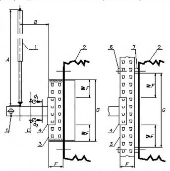
т — шток гидроцилиндра испытательной установки; 2 — рама испытательной установки; 3 — элемент стойки;
