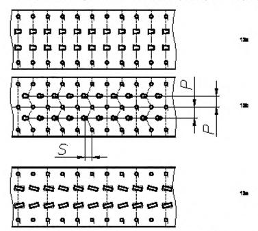
а) нешахматное расположение отверстий; b) шахматное расположение отверстий, c) наклонные отверстия
