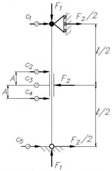
A — расстояние между датчиками,  $a_1$  —  $a_5$  — датчики перемещения; F1 — осевая нагрузка; F2 — поперечная нагрузка; I — расстояние между шарнирами
