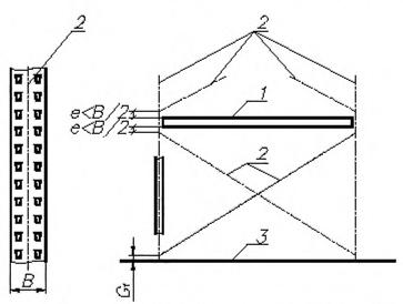
1 — балка; 2 — центральные оси элементов; 3 — пол; В — ширина стойки; е — эксцентриситет (расстояние между узлом раскоса до верхней или нижней части балки); G<sub>s</sub> — расстояние от пола до нижней точки узла раскоса
