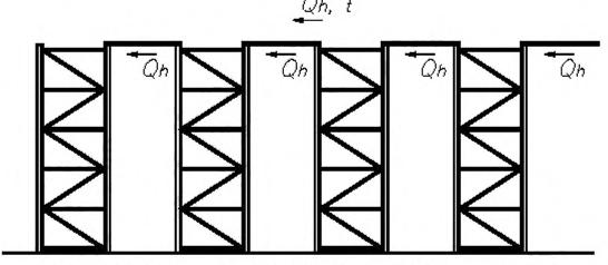
Рисунок 12 — Горизонтальные нагрузки от оборудования, опирающегося на конструкцию степлажей.
