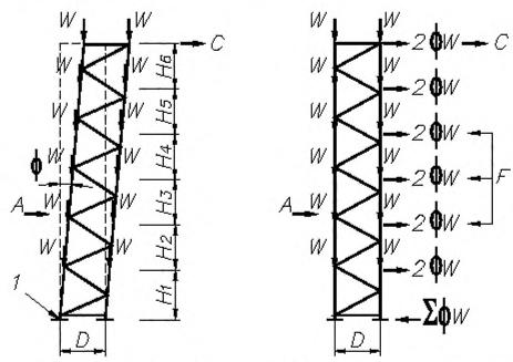
f — оси, проходящие через центр масс полного поперечного сечения стоек, A — нагрузка при размещении;
