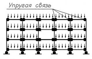
Рисунок 27с — Дополнительная схема нагружения при нахождении нижней балки возле уровня пола
