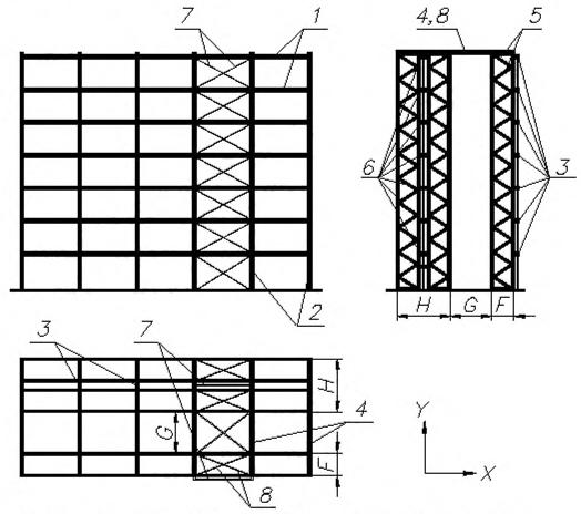
1 — балки; 2 — рамы; 3 — кронштейны раскосов жесткости; 4 — связь над рабочим коридором (при необходимости);
