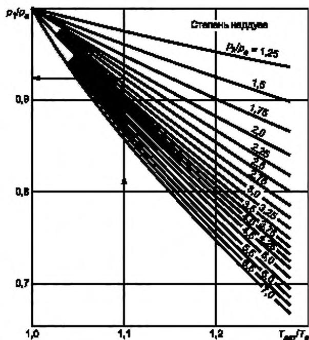
$p_0$  — давление окружающей среды при испытаниях;  $p_1$  — давление воздуха после дросселя;  $p_k$  — давление воздуха на выходе из компрессора;  $T_0$  — температура окружающей среды при испытании;  $T_{00}$  — температура окружающей среды на месте установки двигателя
