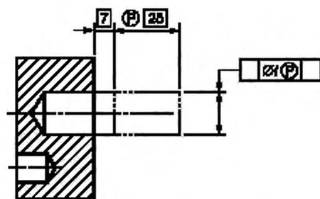
Рисунок 58 — Пример прямого указания смещенного выступающего поля допуска
