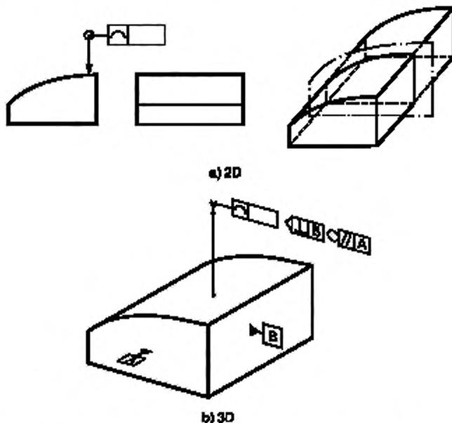
**Примечания** — При установлении допуска формы заданного профиля, если пересекающая плоскость и плоскость набора совпадают, то знак плоскости набора можно не указывать.
