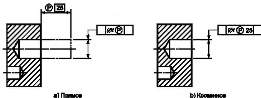
Рисунок 56 — Способы указания выступающего поля допуска
