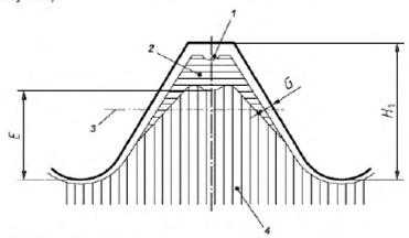
1 – зона полного обезуглероживания; 2 – зона частичного обезуглероживания или ферритного обезуглероживания; 3 – линия среднего диаметра резьбы; 4 – зона основного металла;
