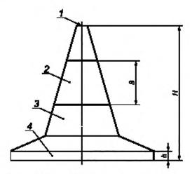
Н — высота конуса. h — толщина внешнего края опорной плиты, S — ширина световозвращающей поверхности полосы белого цвета 1 — вершина тела дорожного конуса, 2 — световозвращающая поверхность, 3 — тело дорожного конуса.
