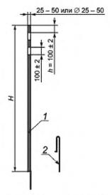
7 — корпус дерожной сигнальной вехи; 2 — элемент монтажа дорожной сигнальной вехи; H — высота (в соответствии с таблицей 6); h — длина световозвращающих элементов
