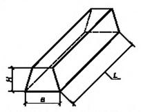
— длина дорожного сепаратора (делиниатора), В — ширина основания дорожного сепаратора (делиниатора),
