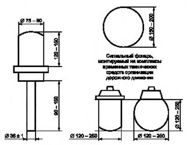
Рисунок 1 — Примеры схем сигнальных фонарей
