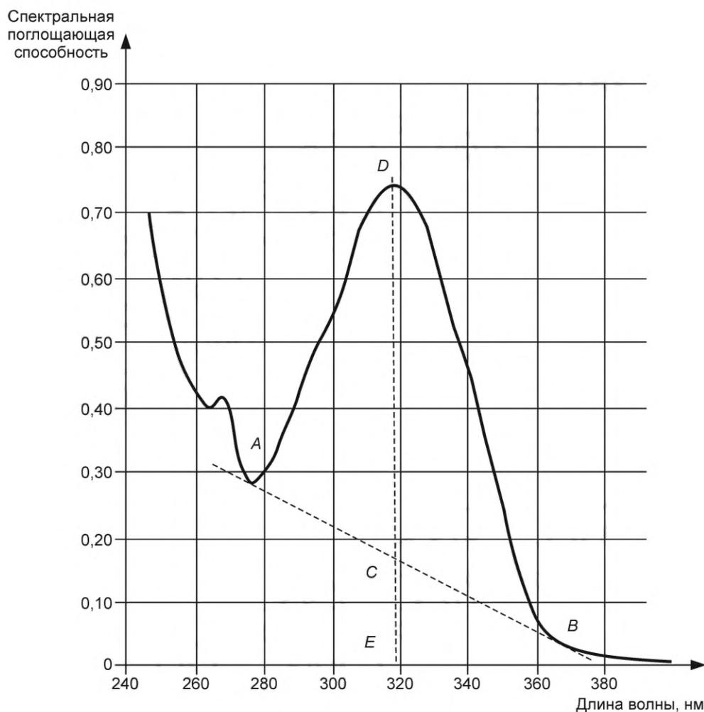
Рисунок 1 — Типичная кривая спектральной поглощающей способности
